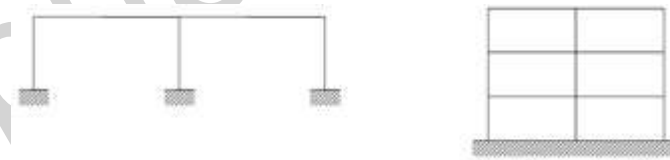
Figura C7.4.4 - Strutture a telaio con collegamenti monolitici
