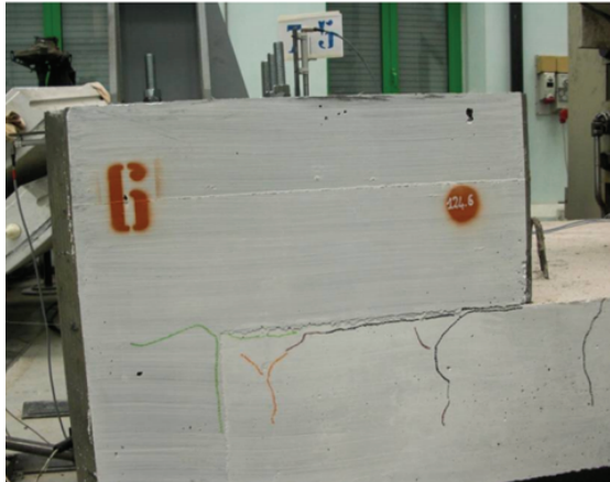
Figura 25 - Quadro fessurativo tipo sulle due superfici del cordolo
