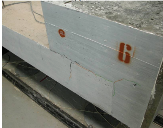
Figura 25 - Quadro fessurativo tipo sulle due superfici del cordolo
