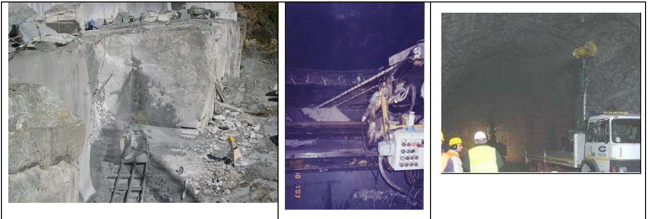
Fig.1: Tagliatrice a filo, a catena e nebulizzatore a getti di aerosol d'acqua
