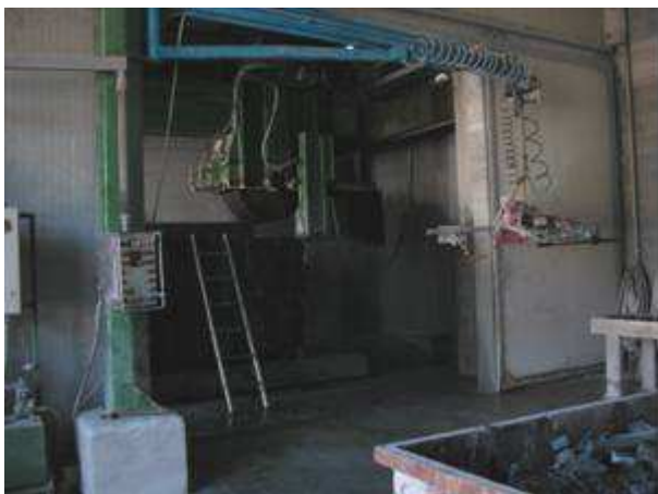
Fig.2: segatrice multipla ad acqua
