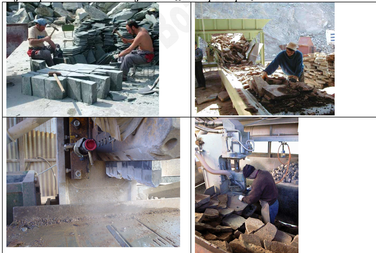
Fig.3-4: spaccatura a macchina con getti nebulizzati d'acqua e aspirazione
