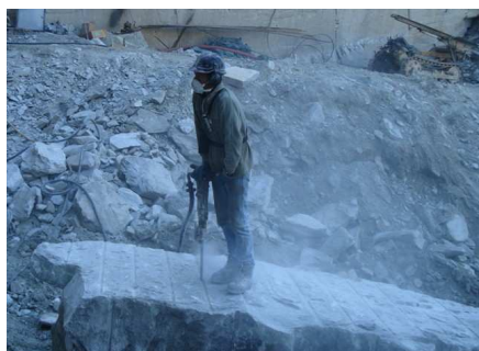
Fig.1-2-3: Perforazione manuale classica e con aspirazione a boccaforo
