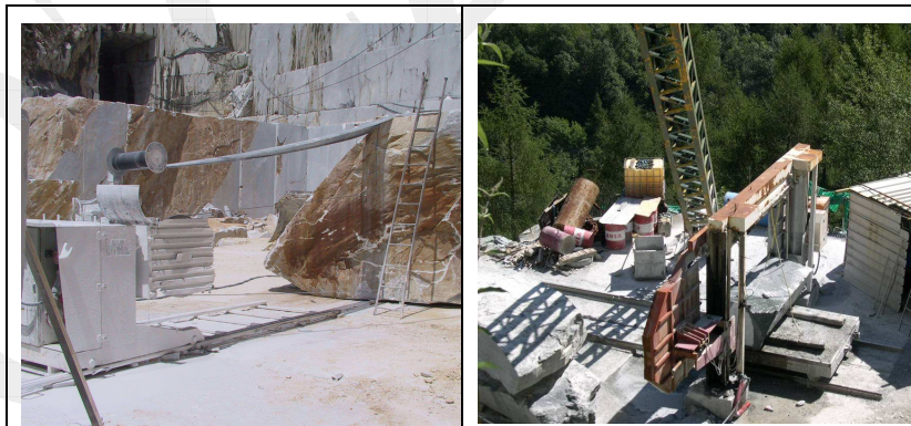
Fig. 1: Riquadratura bancata con tagliatrici a filo
