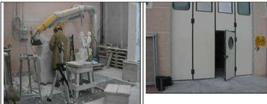
Fig.5-6: Cappe aspiranti orientabili (3) e griglia a pavimento (4)
