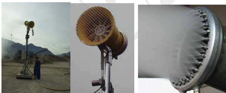
Fig.2: Impianto di abbattimento mediante nebulizzazione di acqua ("cannone")
