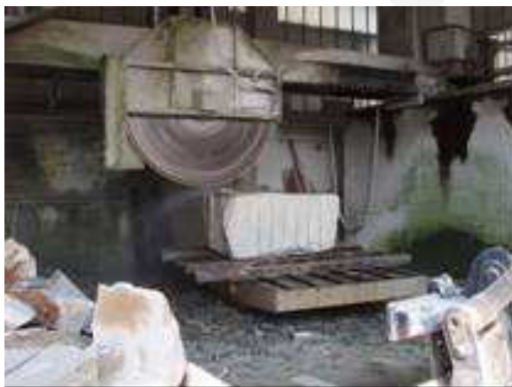
Fig.1-2: Riquadratura con tagliatrice e telaio a filo
