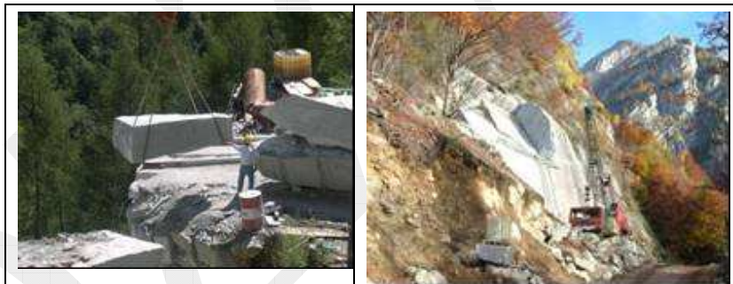
Fig.2: Movimentazione meccanica con mezzi di sollevamento fissi
