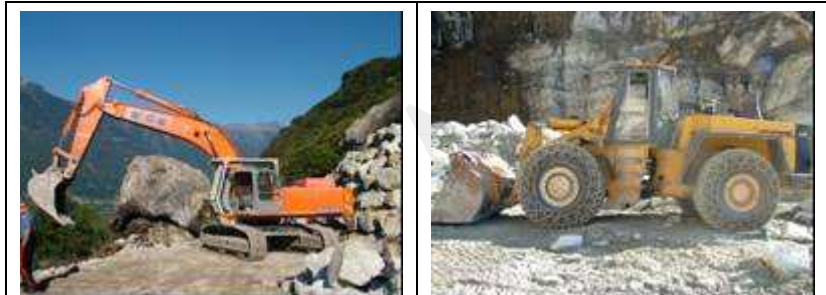
Fig.1: Movimentazione meccanica con automezzi di sollevamento cingolati e gommati
