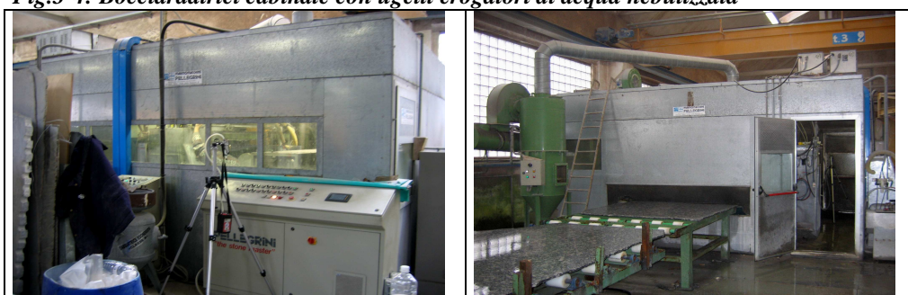
Fig.3-4: Bocciardatrici cabinate con ugelli erogatori di acqua nebulizzata
