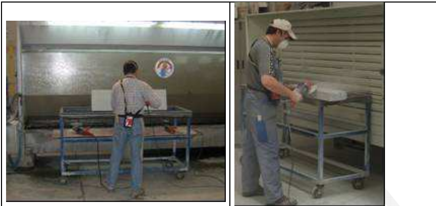
Fig.3-4: Parete aspirante ad acqua (1) e parete multifessura aspiranti a secco (2)
