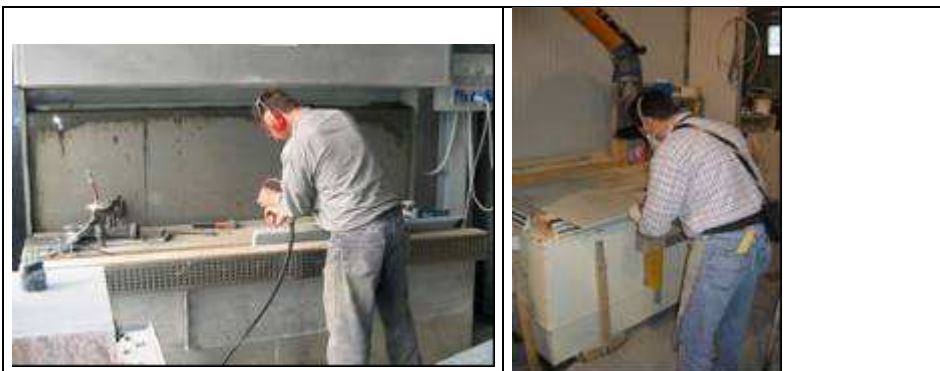
Fig.7-8: Banco aspirato con parete ad acqua o con proboscide (5)
