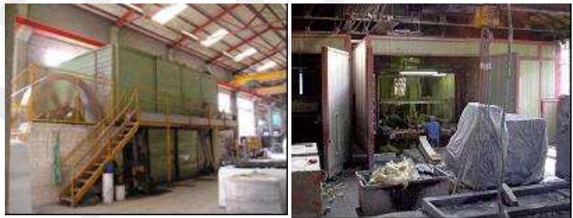
Fig.2: Taglio blocchi con telai multilame in box senza aspirazione
