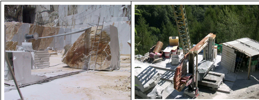
Fig.1-2: Riquadratura con tagliatrice e telaio a filo
