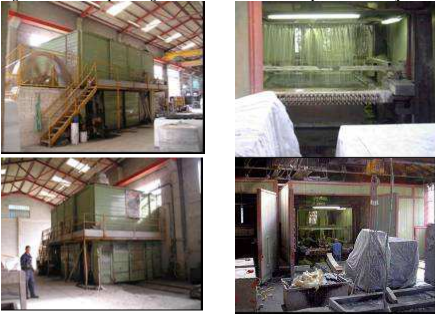
Fig.1-2-3-4: Telaio per il taglio di blocchi di ardesia incapsulato in box (piccolo laboratorio - Liguria)
