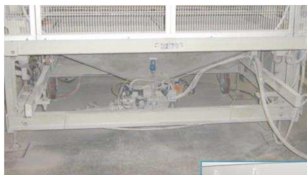
Propulsore pneumatico per il recupero delle polveri della tramoggia sotto il carrello
