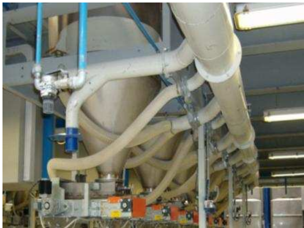
Tubazione con calate per l'aspirazione e raccolta delle polveri aerodisperse all'uscita dei silos.
