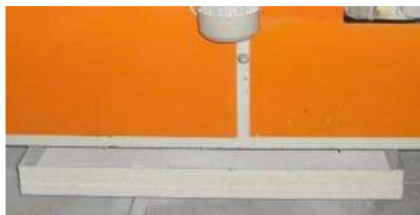
Cassetti per la raccolta delle polveri sotto il convogliatore.
