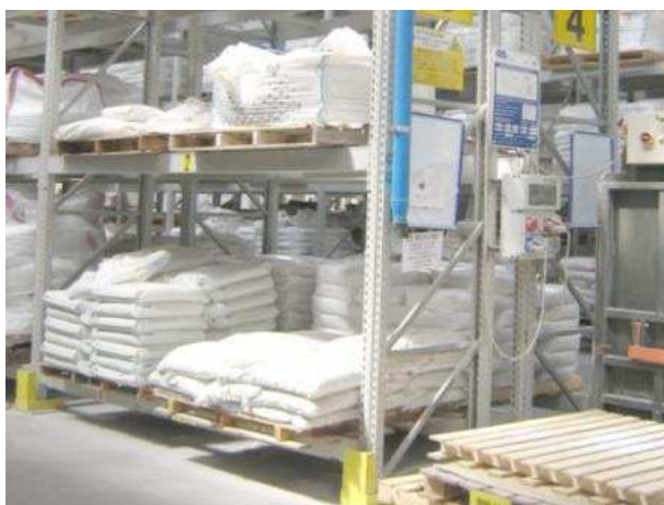
Scaffalatura provvisto di calata (tubo blu) per la pulitura delle polveri.
