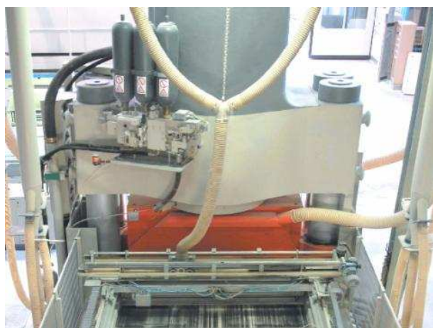
Aspirazione delle polveri sulla traversa posteriore mobile e su tramogge laterali di caricamento
