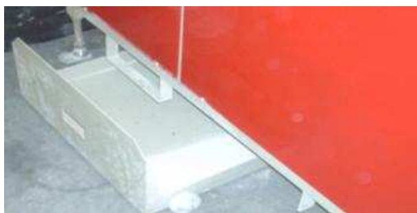
Cassetti per la raccolta delle polveri sotto il convogliatore.
