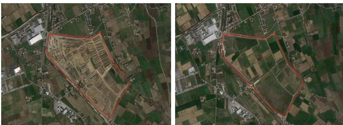
Figura 51 - Esempio di recupero di suolo a seguito del ripristino delle aree di cantiere per la creazione delle casse di espansione per il Torrente Timonchio nel comune di Caldogeno (VI): l'area dell'intervento è di circa 114 ettari (immagini 2015 a sinistra e 2017 a destra).
