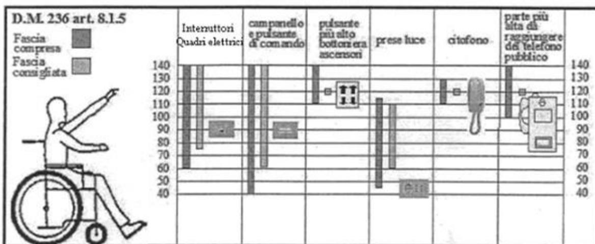
Si ricorda che la fascia di accessibilità compresa tra i 40 e i 140 cm è riferita alle apparecchiature normalmente utilizzate e che si vuole manovrate dall'utente fruitore degli spazi. Si intendono esclusi i componenti installati ad altezze diverse per scelta progettuale al fine di migliorare la sicurezza e l'economia dell'impianto come ad esempio:
