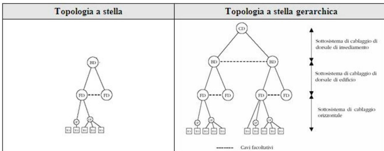
La figure mostrano i sottosistemi e gli elementi funzionali che costituiscono un sistema di cablaggio strutturato:
