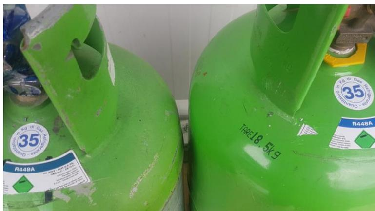
Le miscele a base HFO che risultano adatte a sostituire l'R404A, in linea di massima, si rivelano anche degni sostituti della serie di refrigeranti R407 (es. R407F, R407A ecc.), con l'esclusione dell'R407C che si utilizzava per condizionamento aria.
