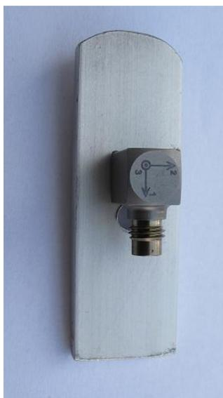
*Fig. 1 - Accelerometro Dytran su supporto in alluminio.*
