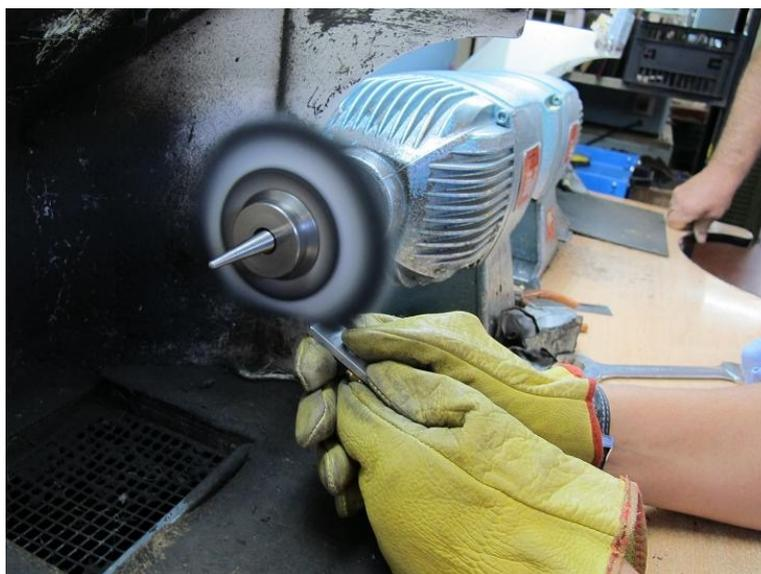
*Fig. 2 - Misure di vibrazioni per operazione di pulimentatura metalli.*
