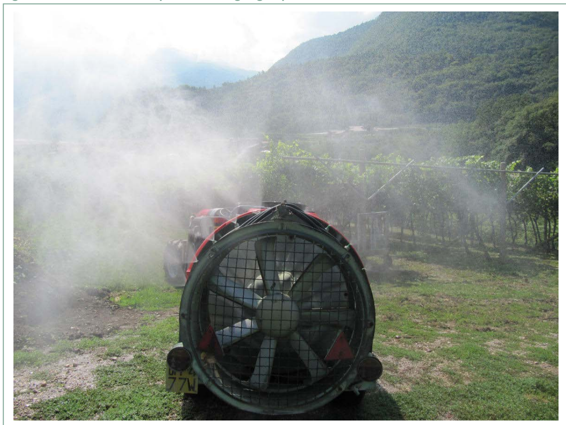
Figura 1: Macchine irroratrici, particolare degli ugelli per l'irrorazione
