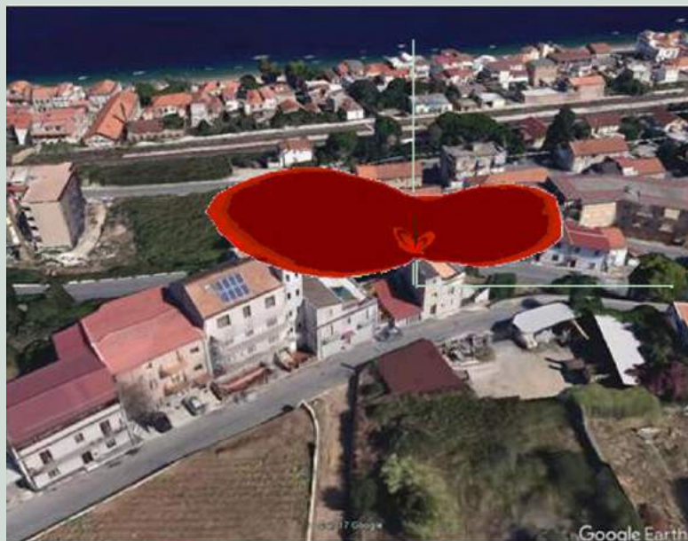
Figura 1: Volume di rispetto a 6 V/m del livello di campo elettrico generato dalla SRB da progetto originario con condizioni in situ
