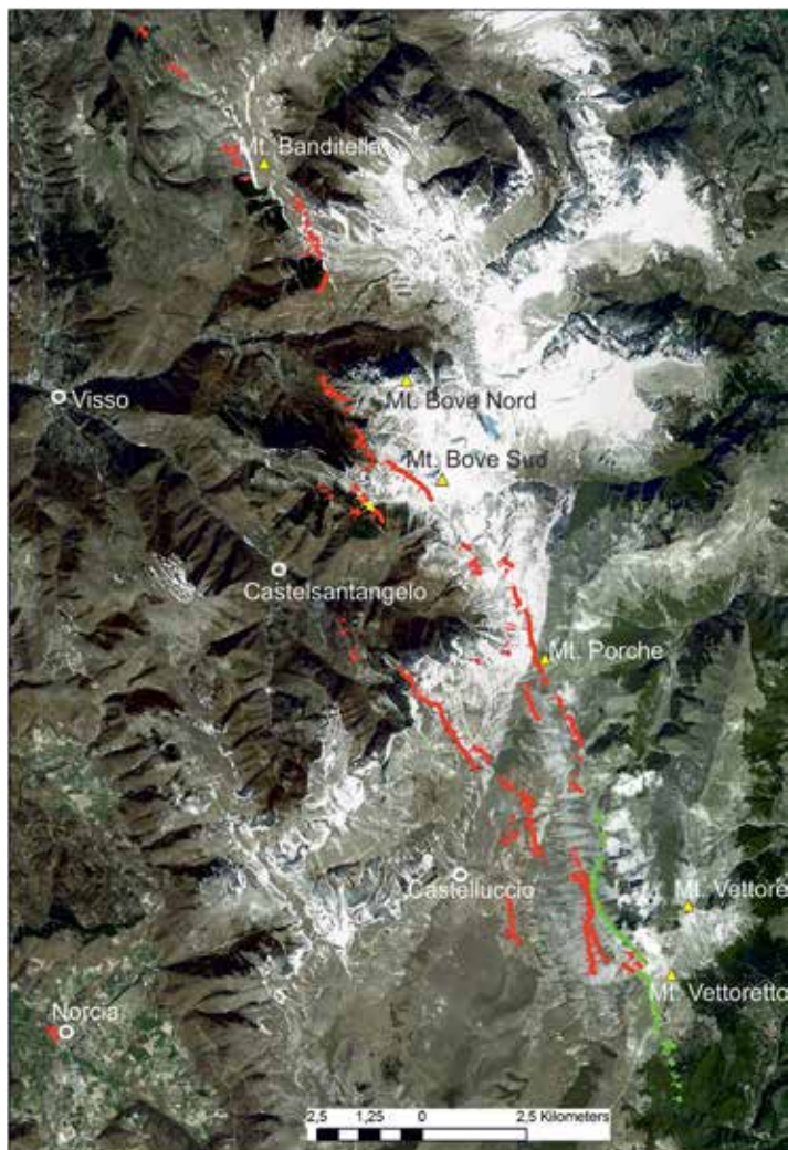
Figura 15.2: La fagliazione superficiale multipla associata alle tre scosse principali della sequenza sismica che ha colpito il Centro Italia nel 2016 (24 agosto, in verde; 26 ottobre, in giallo; 30 ottobre, in rosso, verde e giallo)
