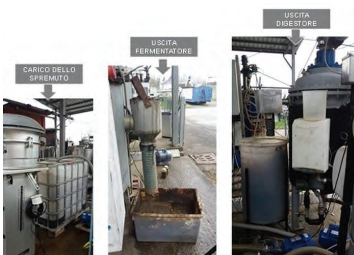
Figura 13 - Immagine dei punti di carico e scarico degli influenti ed effluenti nell'impianto pilota oggetto dell'indagine
