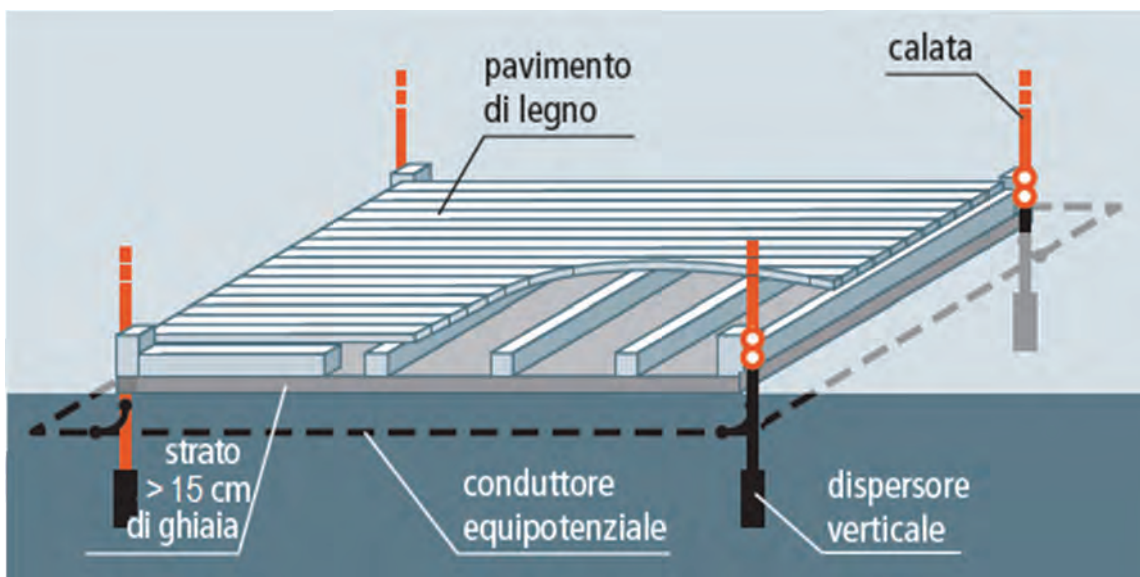
Figura 49b: Pavimento di rifugio realizzato con strato di ghiaia e tavole di legno
