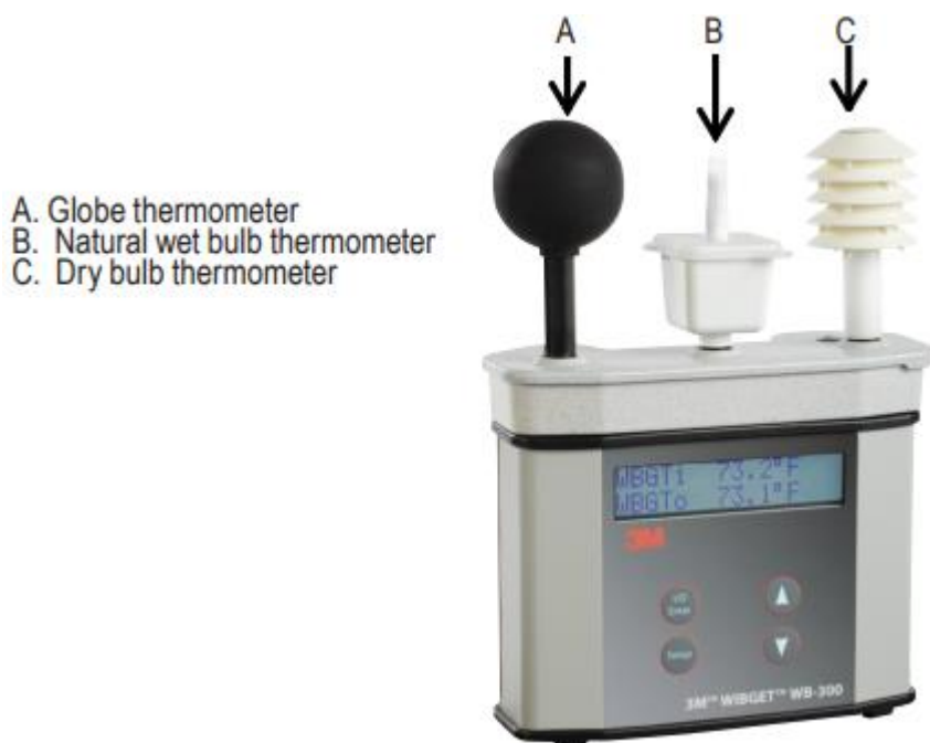
Figura 2. Misuratore WBGT con sensore a bulbo umido naturale e secco
