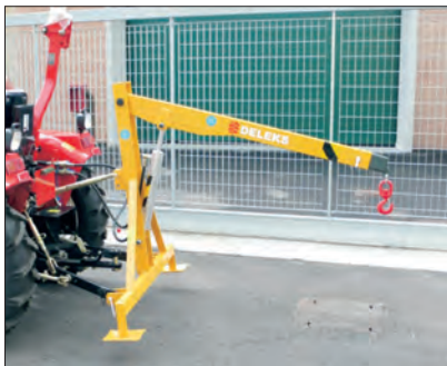
Figura 2 : Gru per trattore non incluse nella EN 12999
