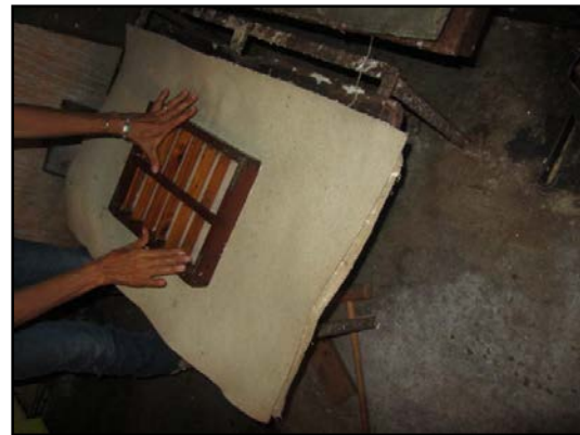
Figura 30. Extracción del contramarca y colocado sobre un fieltro. Foto: Jacqueline Joseau.
