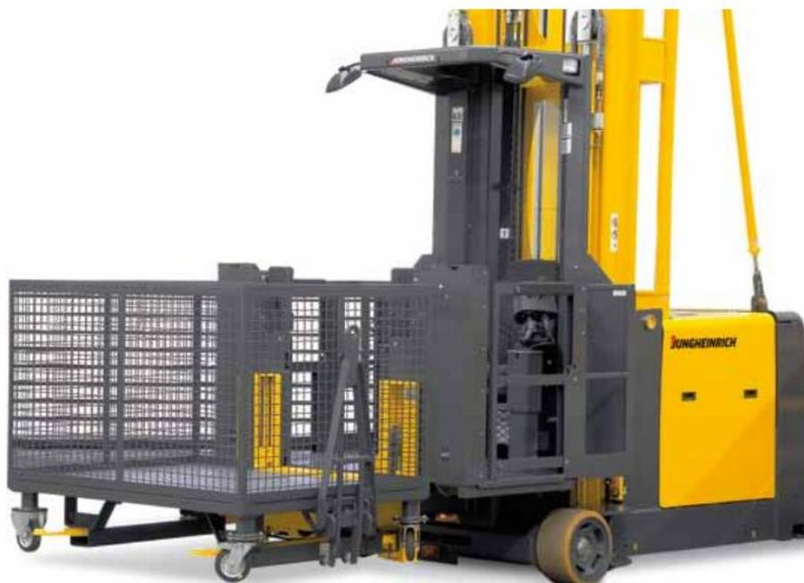
Figura 46 - Interruzione abbassamento per una cesta da commissionamento
