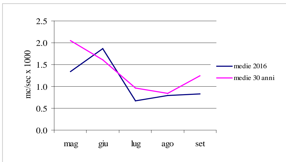
Figura 4.8 – Confronto tra medie mensili delle portate del Po con le medie storiche degli ultimi 30 anni.
