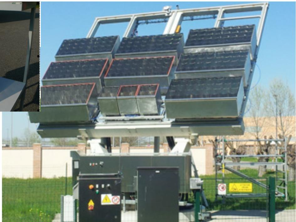
Figura 1b) Test facility per lo studio della tecnologia del fotovoltaico ad alta concentrazione installata presso la sede RSE di Piacenza
