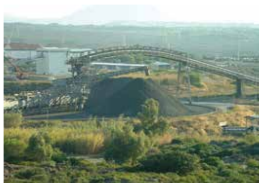
Omogeneizzatore: il minerale grezzo in uscita dal sottosuolo viene accumulato all'esterno e distribuito per creare una alimentazione uniforme all'impianto di trattamento. La capacità del piazzale è di 30.000 tonnellate (Foto Carbosulcis)
