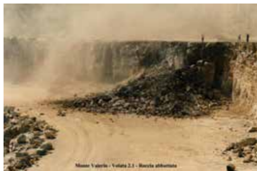
Giovedì, 18 aprile 2002 - Sequenza di una volata di mina progettata da tecnici del Servizio Ispettivo per la Sicurezza Mineraria, nel corso di prove per le misure di vibrazioni indotte da volate di mina su strutture circostanti l'attività mineraria di Monte Valerio (MS) (Foto V. Correggia)
