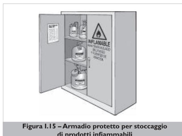
**Figura I.15** – Armadio protetto per stoccaggio di prodotti infiammabili
