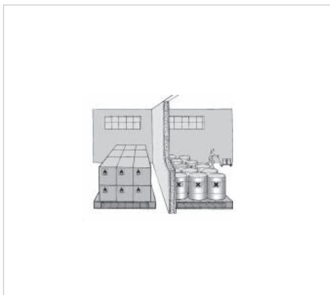
Figura I.26 – Settorizzazione mediante tramezzo tagliafuoco
