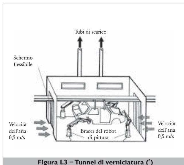
**Figura I.3 – Tunnel di verniciatura (\*)**
