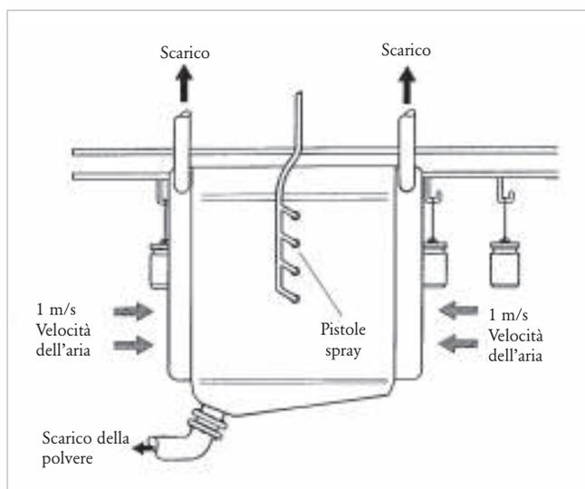
**Figura I.4 – Cabina di verniciatura elettrostatica (\*)**
