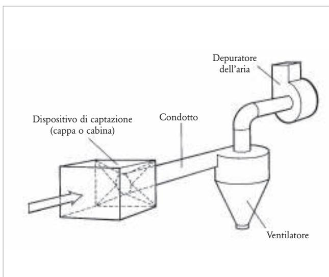
Figura I.8 - Elementi di un sistema di estrazione localizzata
