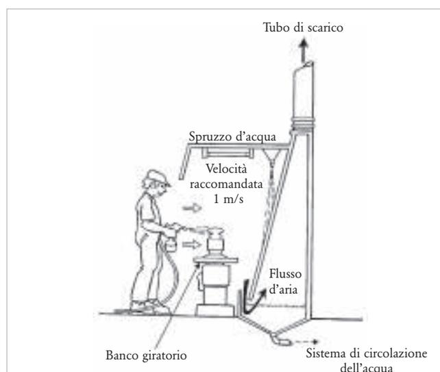
Figura I.13 - Cabina di verniciatura (\*)
