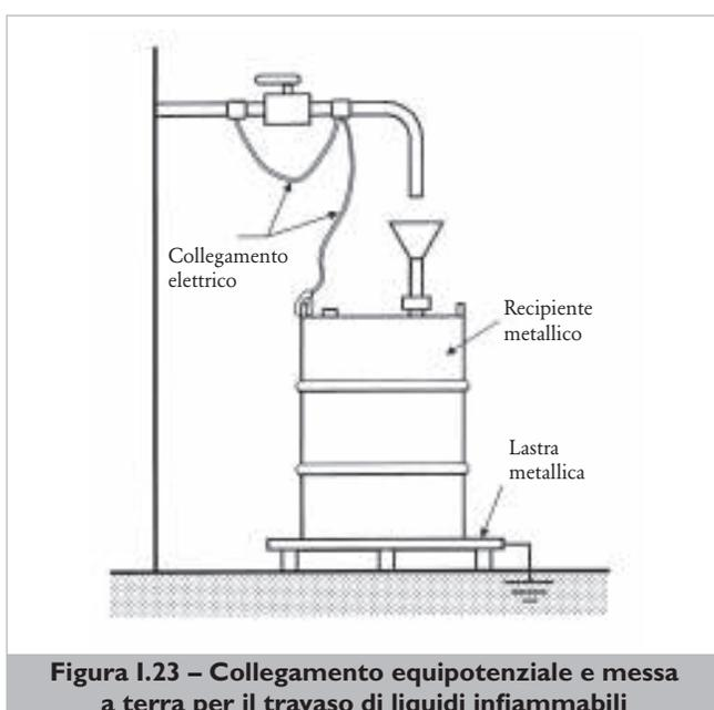
Figura I.23 – Collegamento equipotenziale e messa a terra per il travaso di liquidi infiammabili
