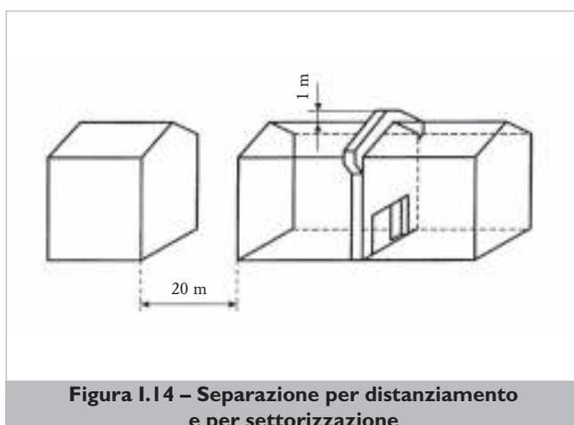
**Figura I.14** – Separazione per distanziamento e per settorizzazione
