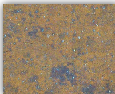
Figura 8.37 - Magna Grecia: campione di rame scoperto (ingrandimento: 40x)
