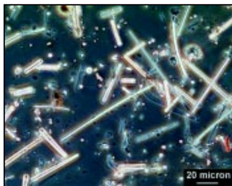
Figure 15 e 16: immagini al MOCF (obiettivo 40x) di campioni di particolato aerodisperso relativi alla rimozione (a sx) e all'applicazione (dx), a secco, di FCR.
