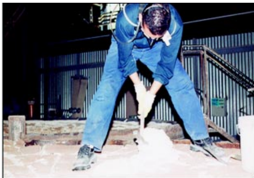
Figura 5: Rimozione del materiale in FCR dal coperchio di una siviera
