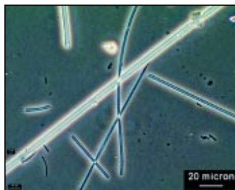
Figure 15 e 16: immagini al MOCF (obiettivo 40x) di campioni di particolato aerodisperso relativi alla rimozione (a sx) e all'applicazione (dx), a secco, di FCR.
