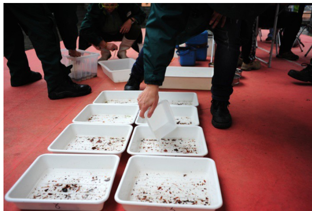
Figura 1B – Preparazione dei campioni: riempimento delle vaschette grandi con il campione omogeneizzato utilizzando una piccola vaschetta dosatrice.
