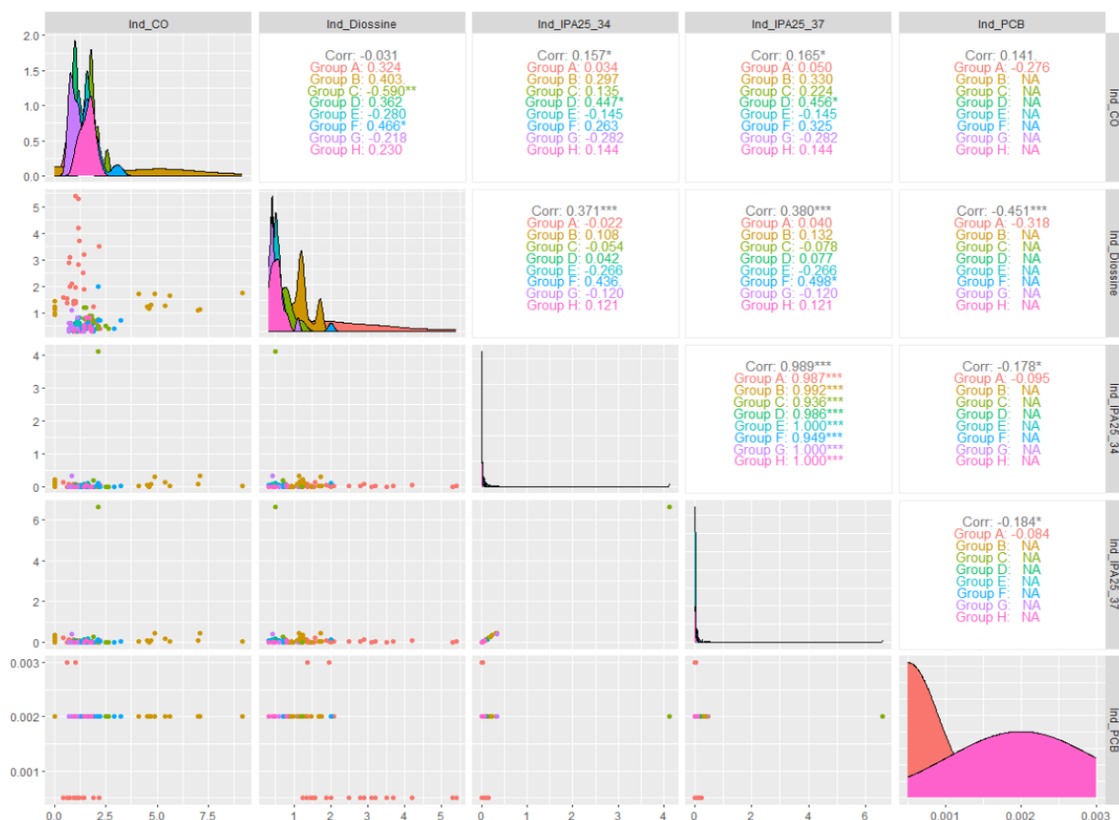
Figura 19 Scatter plot tra gli indicatori principali presi in esame distinguendo per il fattore "Grouping". I valori NA e "?" sono presenti in quanto non vi è variabilità del dato perché i valori dei PCB sono tutti uguali ovvero sotto LoQ.
