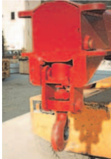
Fig. n. 14: dettaglio gancio a rotazione comandata
