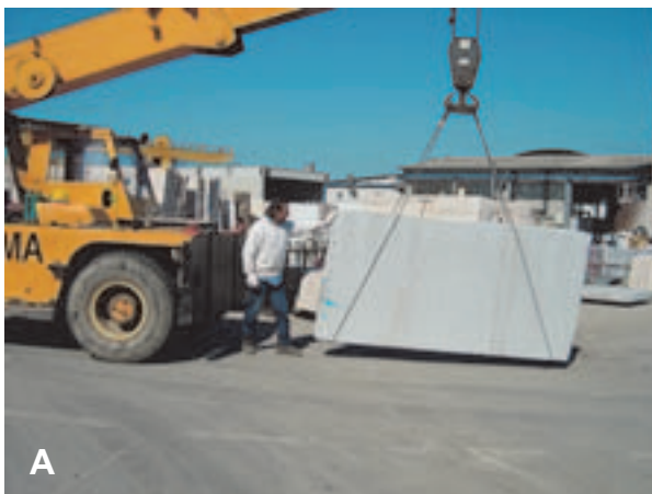
Fig. n. 12: Posizione per l'operatore a terra: A) ad elevato rischio di schiacciamento - B) in sicurezza
