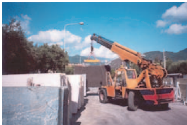
Fig. n. 28: Trasporto lastre con bilancino
