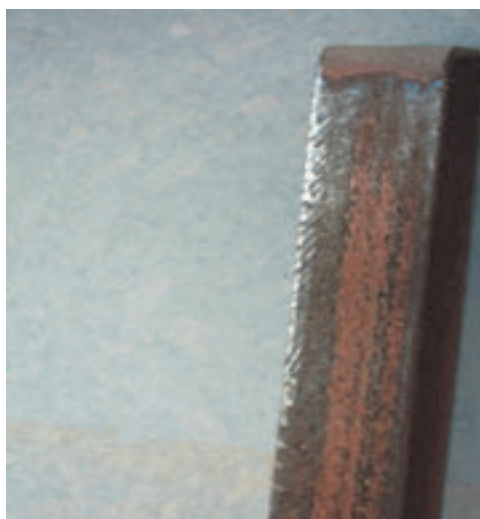
Fig. n. 32: Dettaglio segni di usura causati dalle brache sulle caprette.
