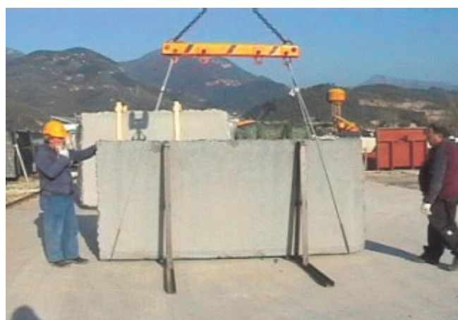
Fig. n. 29: Deposito pastello con bilancino
