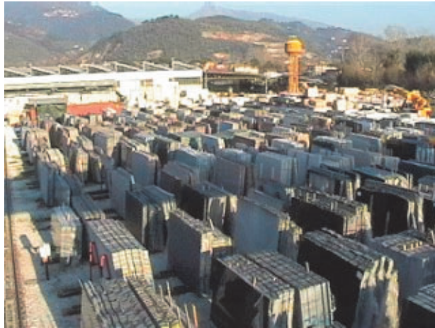
Fig. n. 41: Piazzale di stoccaggio con caprette
