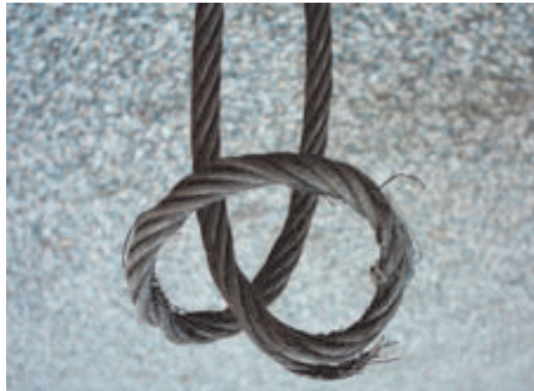
Fig. n. 16: Braca deformata e danneggiata
