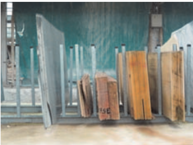
Fig. n. 44, 45: Stoccaggio con paletti (rastrelliere)
