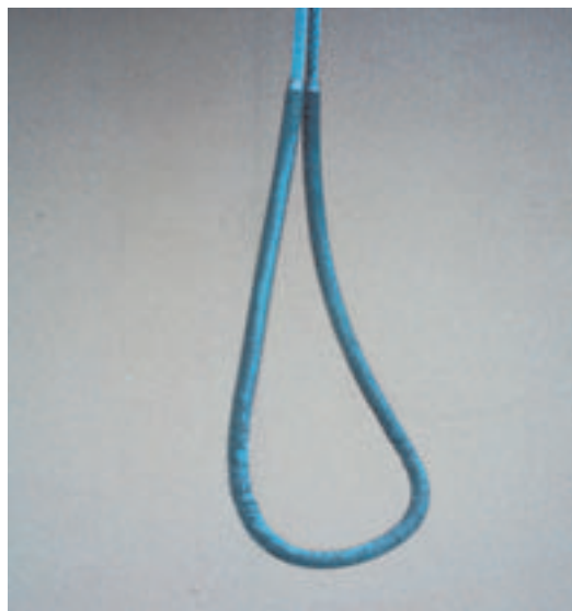
Fig. n. 21: Braca deformata dopo l'uso prolungato.
