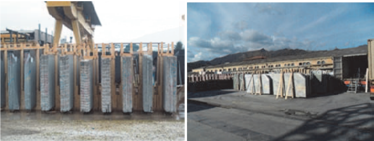
Figg. n. 50, 51: Stoccaggio con legacci
