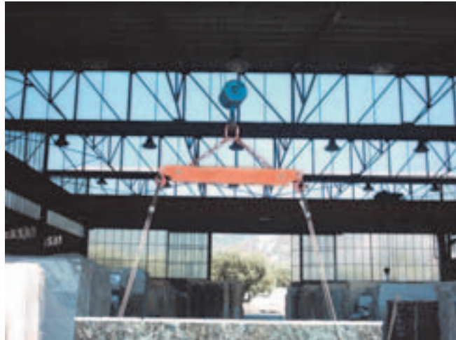
Fig. n. 39: Imbracatura pastello con bilancino standard
