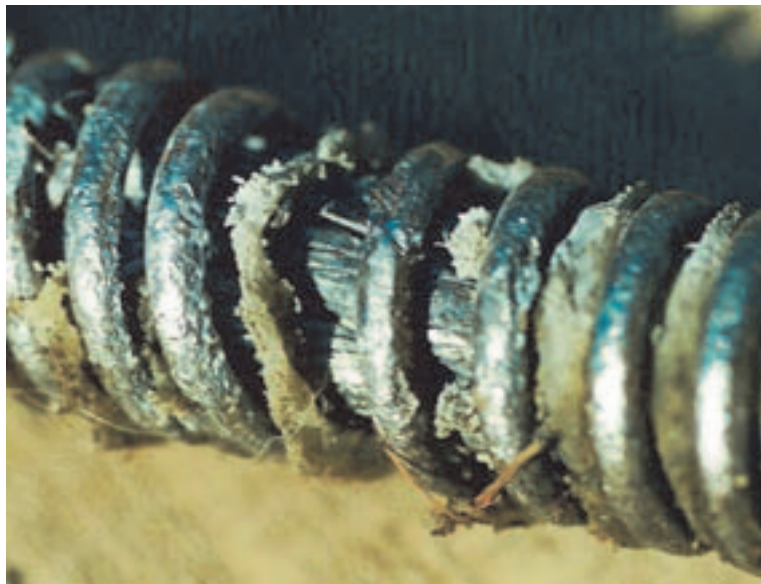
Fig. n. 22: Braca con rivestimento rotto (deve essere sostituita).
