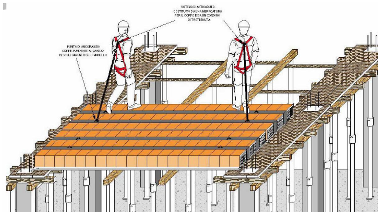
Figura 17. Schema di aggancio al pannello già posato<sup>45</sup>.
