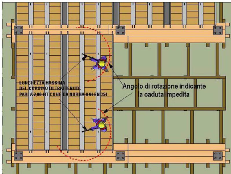
Figura 18. Schema di aggancio al pannello già posato con linea di ingombro del raggio d'azione del cordino a completa trattenuta<sup>48</sup>.
