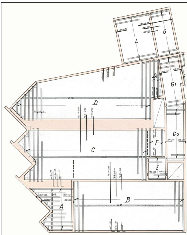
Figura 11. Impiego di solai a travetti in grado di adattarsi agevolmente alla configurazione planimetrica dell'edificio<sup>38</sup>
