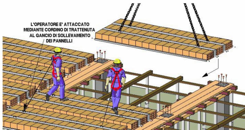
Figura 9. Continuità del piano di lavoro in un solaio a pannelli<sup>37</sup>
