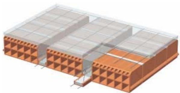
**Figura 7.2. Solaio a travetti tralicciati**
