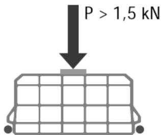
Figura 20. Applicazione del carico di prova ad un elemento interposto in laterizio<sup>53</sup>.
