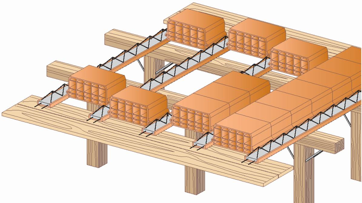
Figura 8. Solaio a travetti. Il rischio di caduta dall'alto permane anche successivamente alla posa dei travetti<sup>36</sup>
