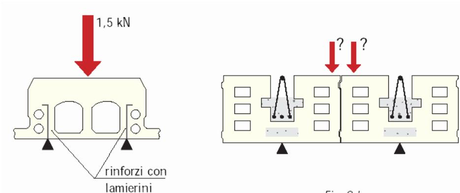
Figura 21. Esempio di blocco in polistirolo irrigidito da due lamierini: verifica della resistenza a punzonamento mediante carico concentrato<sup>54</sup>.
