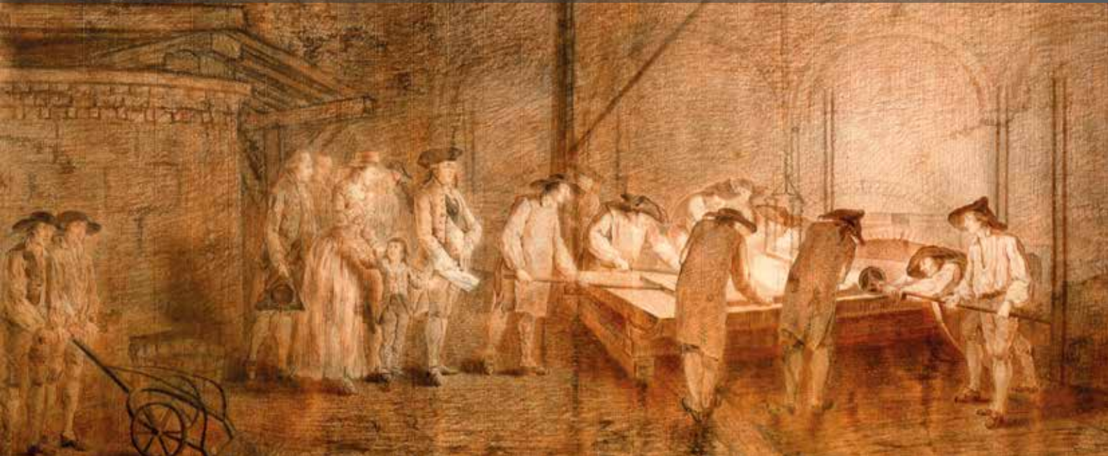
Vetro colato per specchi da Saint-Gobain alla presenza del direttore Pierre Delaunay-Deslandes, ca. 1780.
