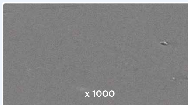
Immagine ingrandita di un vetro per doccia TIMELESS® utilizzato quotidianamente: nessuna asperità visibile, aspetto trasparente.
