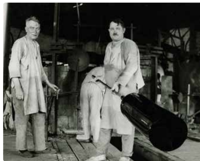
Verrerie de Saint-Just negli anni '30: operaio che tira un cilindro nel forno a pozzo.
