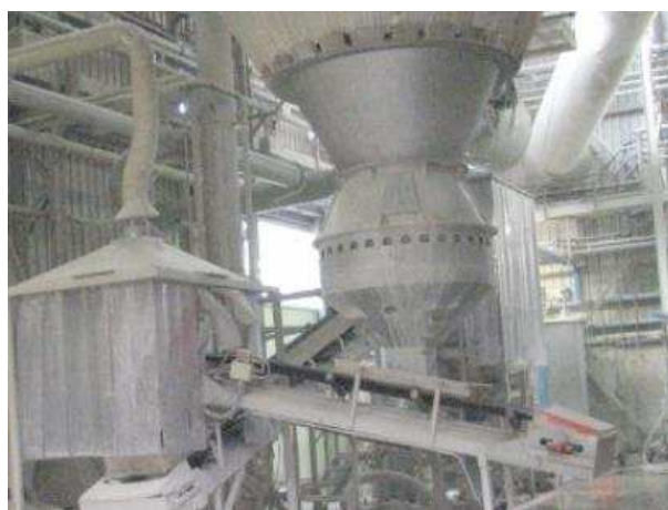
Anello raffreddatore e cappa aspirata con bandelle
