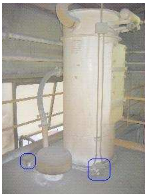
Particolari: gli agganci per lo scarico pneumatico e il microcontatto del circuito di controllo.
