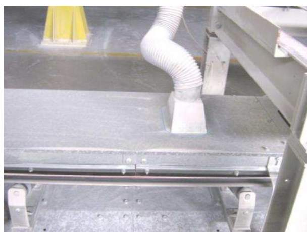
Segregazione dei riavvolgimenti, punti di caduta e aspirazione
