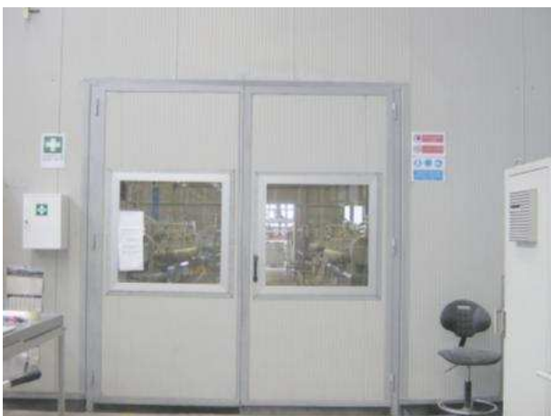
cabinatura che racchiude le operazioni dispersive (squadatura, levigatura, ecc.).
