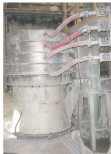
A dx.: vibrosetaccio multiplo per barbotine.
