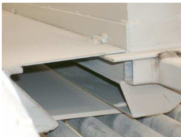
Soffiatura delle piastrelle ed aspirazione delle polveri: particolari.
