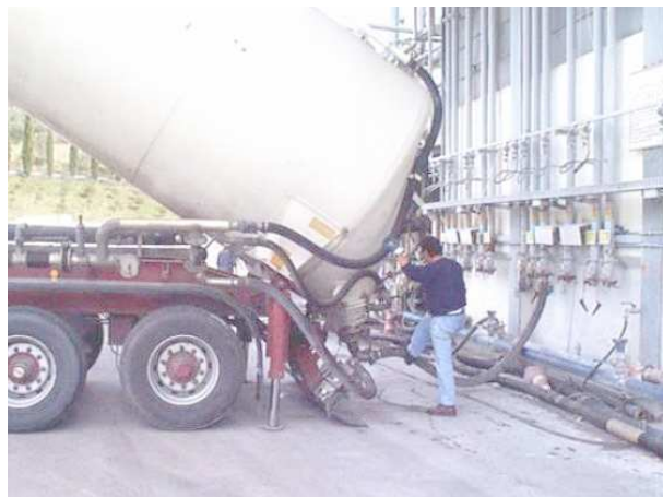
Rimorchio con cisterne in parcheggio. Scarico pneumatico da cisterna della materia 1 a .
