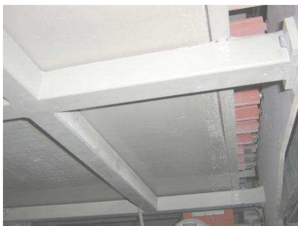
Sotto la rulliera un pannello convoglia le polveri nel punto di raccolta, evitando la caduta al suolo.
