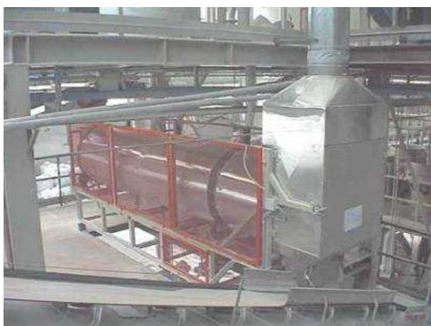
Macchina raffreddatrice dell'atomizzato
