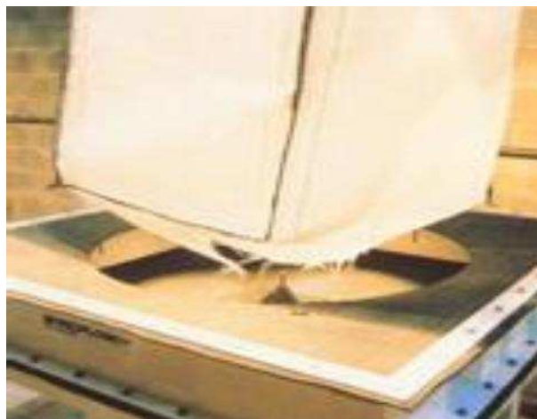
supporto per il sostegno del saccone e sottostante punta per lacerare il saccone monouso
