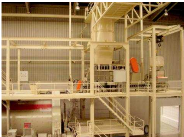
Sopra: Apparato per il carico del mulino continuo.
