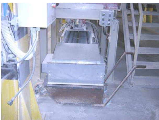
Segregazione dei riavvolgimenti, punti di caduta e aspirazione
