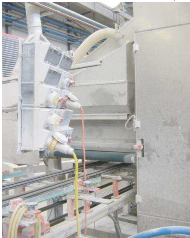
Sopra e a sx.: Applicatore per polveri e graniglie. Visibili l'entrata, l'uscita e il corredo di tubi per l'aspirazione.
