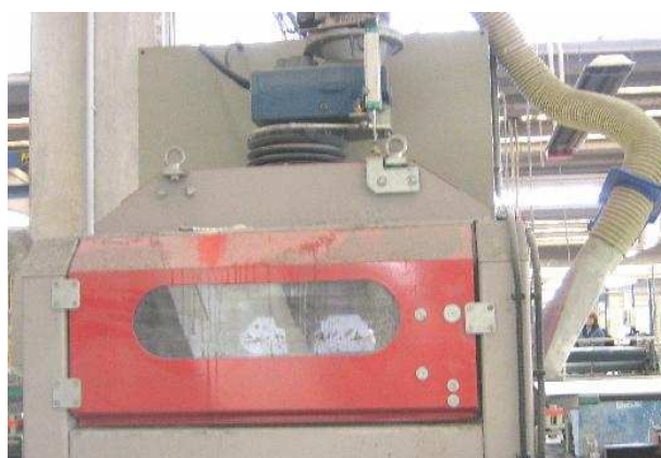
Apparecchiatura cabinata e aspirata per la spolveratura delle piastrelle: linea e particolare.
