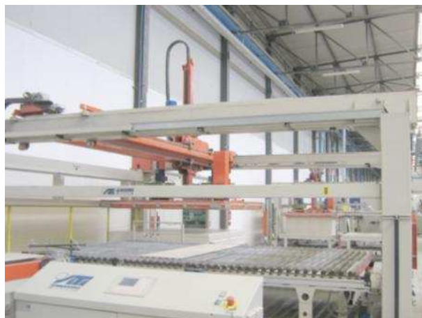
Accatamento con pinza automatica.
