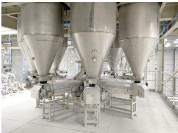
Nastrini dosatori delle polveri dei silo.
