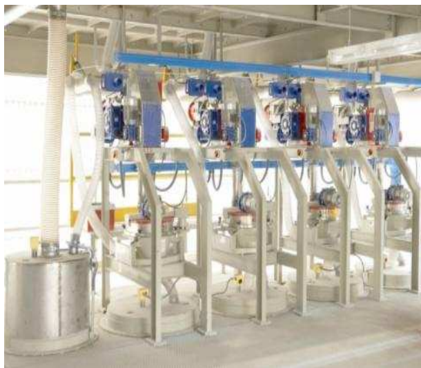
Batteria di scagliatori a rullo
