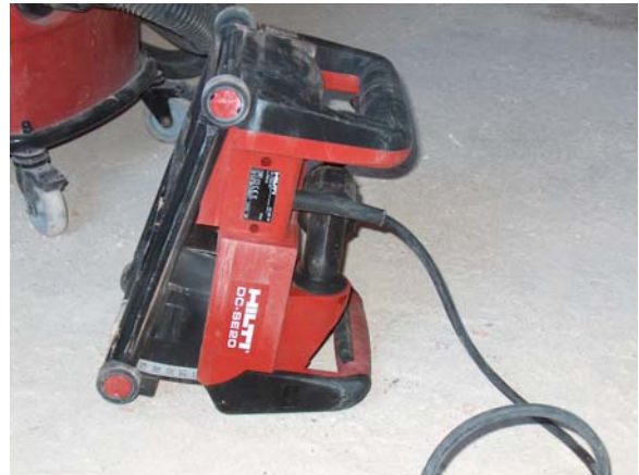
Scanaltrice e impianto d'aspirazione particolare sul sistema di funzionamento e appoggio dell'attrezzo alla superficie
