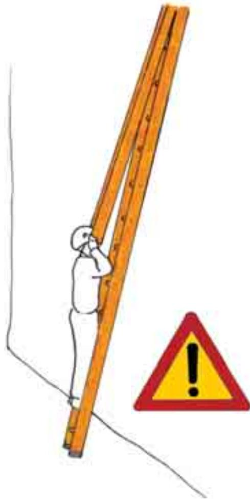
Fig. 39 - Modalità errata di montaggio
