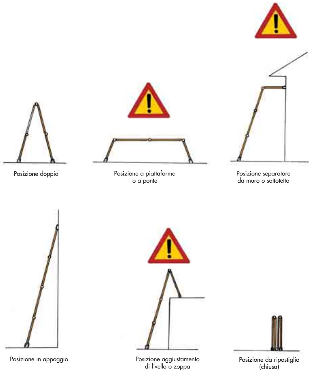
Fig. 46 - Configurazioni di una scala trasformabile multiposizione
