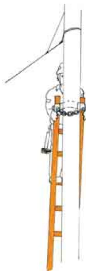
Fig. 19 - Scala in appoggio con dispositivo poggiapalo
