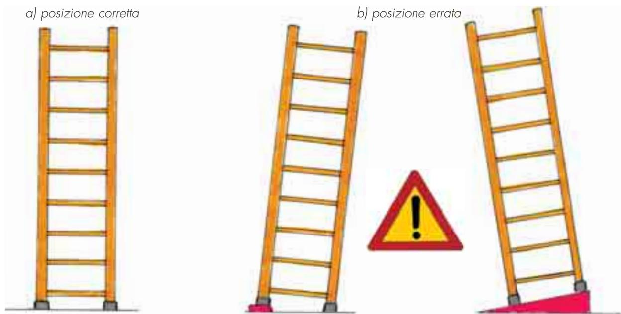
Fig. 25 - Superficie inclinata lateralmente. Appoggiare la scala solo su superficie orizzontale
