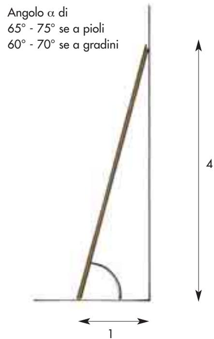
Fig. 29 - Corretta posizione della scala in appoggio
