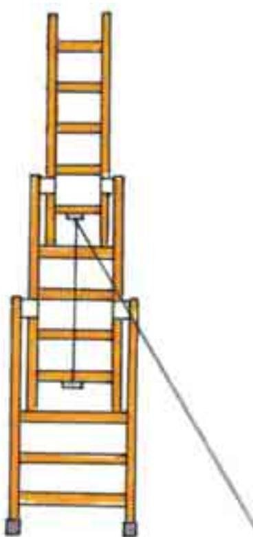
Fig. 15 - Scala a sfilo a sviluppo con meccanismo
