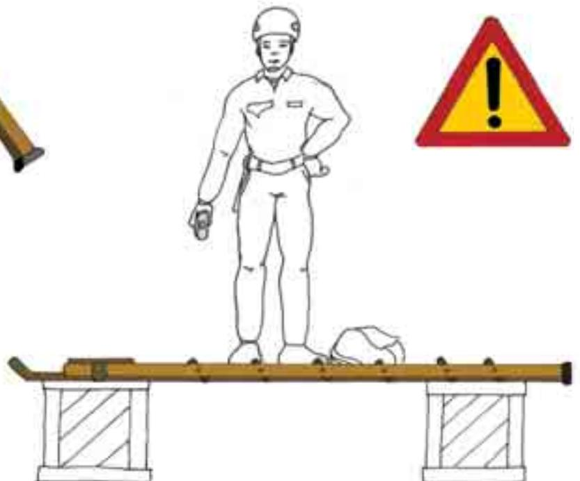
Fig. 9 - Non usare la scala come una piattaforma o passerella
