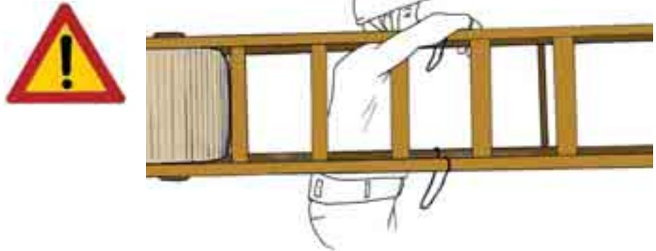
Fig. 8 - Modalità corretta di trasporto della scala a spalla
