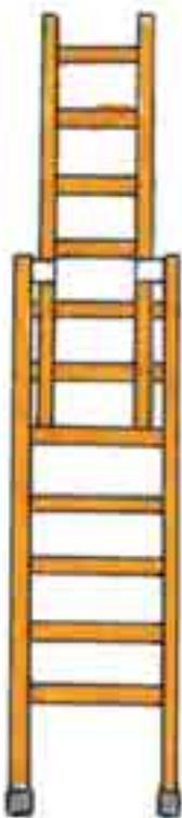
Fig. 14 - Scala a sfilo a sviluppo manuale
