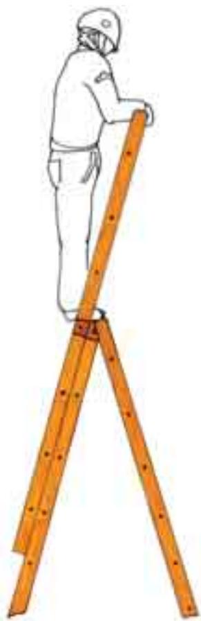
Fig. 49 - Massima altezza di salita in una scala trasformabile
