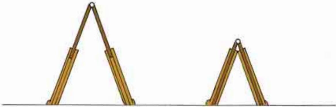
*Fig. 47 - Scala trasformabile telescopica in posizione doppia*
