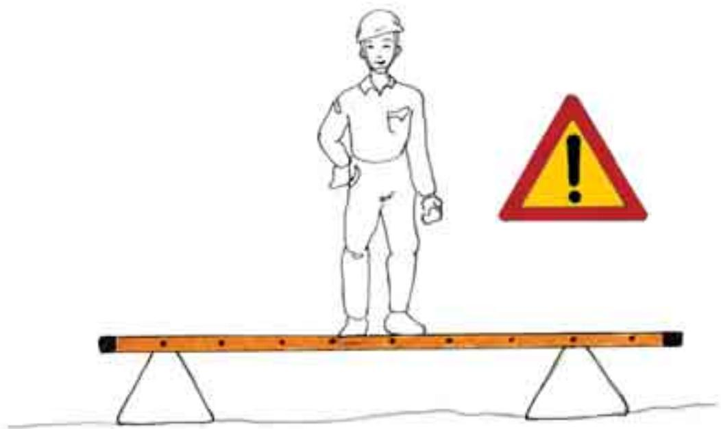
Fig. 28 - Non usare la scala come una impalcatura o passerella
