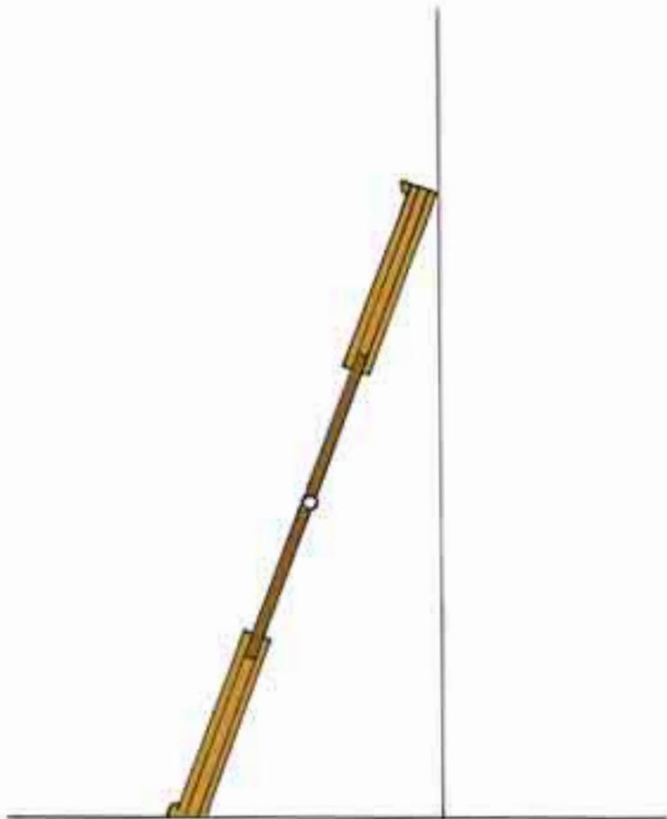
*Fig. 48 - Scala trasformabile telescopica in posizione di appoggio*
