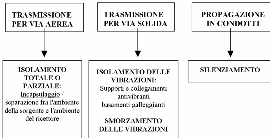
Figura 6.5: Tecniche di controllo della trasmissione sonora
