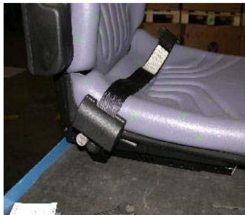
necessario, il carrellista rilascia il pulsante in modo che la cintura rimanga bloccata ma «lenta», anche dopo la chiusura. Una volta presa posizione sul sedile, in appoggio allo schienale, ritorna a premere il pulsante che consente all'arrotolatore di adeguare la lunghezza della cintura alle proprie esigenze. In questo modo l'operatore rimane ancorato al sedile in posizione ottimale. Qualora,
