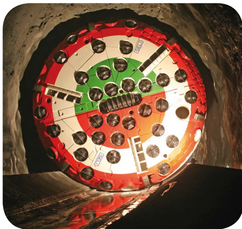
La testa della fresa presenta numerosi cutter. Questi frantumano la roccia in piccoli pezzi che di seguito vengono automaticamente asportati.
