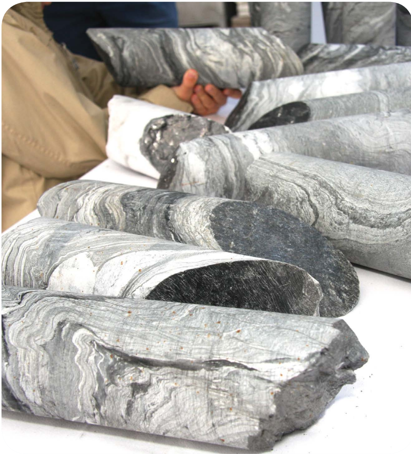
Questi campioni di roccia sono il risultato di sondaggi di prospezione. Informano sulle caratteristiche geologiche dell'ammasso roccioso e formano la base per misure di ottimizzazione.
