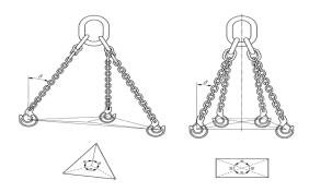
CARICO INSTABILE il gancio non è allineato con il centro di gravità (baricentro). Questa situazione è pericolosa in quanto, una volta sollevato, il carico ruota pregiudicando la stabilità dello stesso e della macchina
