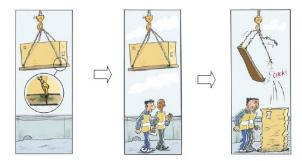
Nel comparto industria vengono impiegati diversi accessori di sollevamento e le differenti tipologie utilizzate dipendono principalmente dalla massa del carico, dalla forma e dal materiale dello stesso carico. Comunque è da rilevare che, indipendentemente dal tipo di industria, i rischi derivanti da un utilizzo non corretto e che possono provocare gravi incidenti possono essere così sintetizzati:
