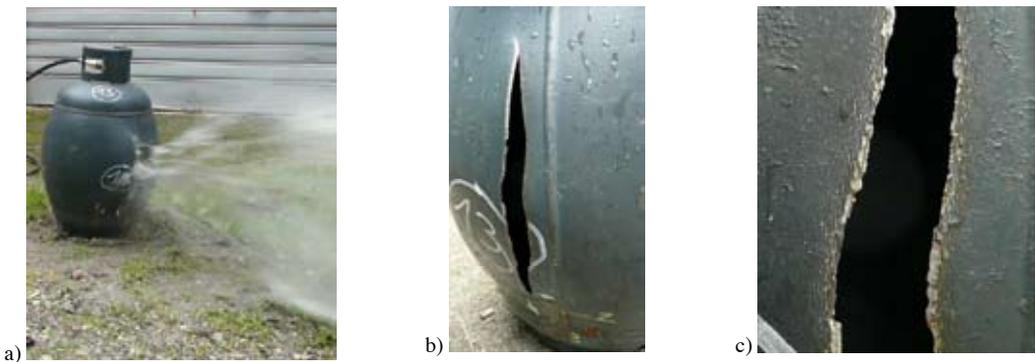
Figura 8 - Scoppio del bidone; caso a) momento dello scoppio; caso b e c) particolare della fessurazione
