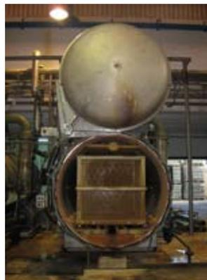
Fig. 4 - Autoclave per cottura
