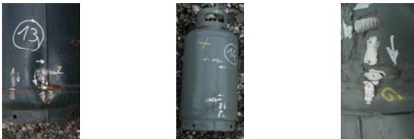
Figura 5 - Rilievo delle durezza. Particolari dei punti di controllo
