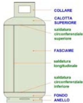
Figura 1 - Schematizzazione del bidone per gpl
