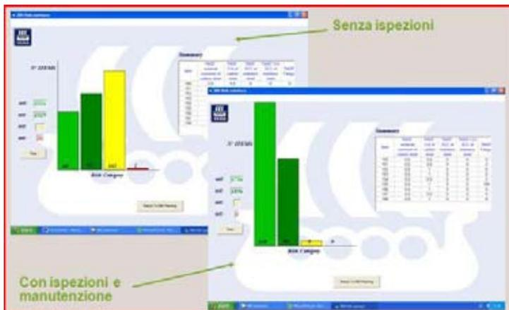
Fig. 6 - RBI, effetto delle ispezioni e manutenzioni sulle categorie di rischio per le tubazioni ammoniacca
