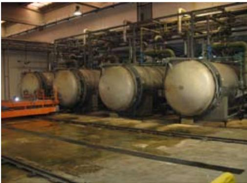
*Fig. 8 - Autoclave e navetta di carico*
