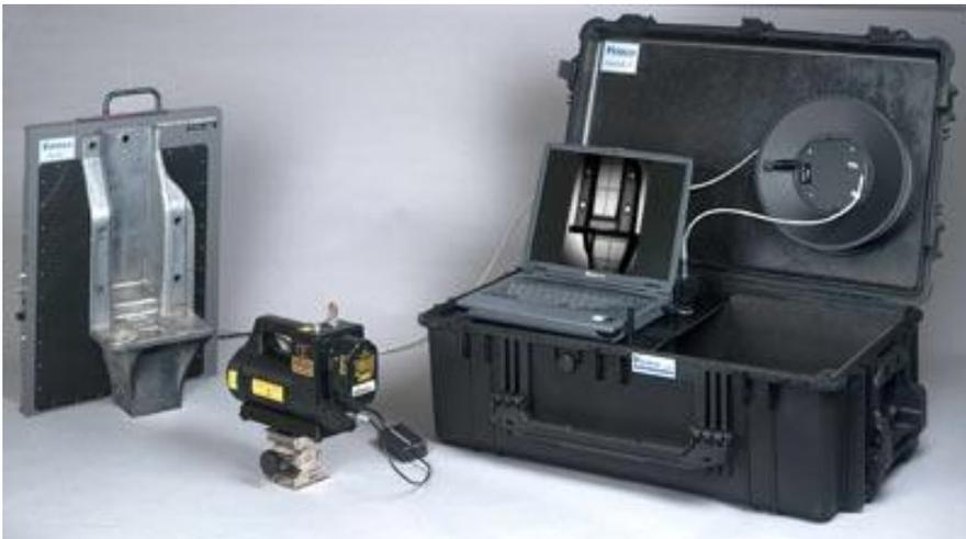
Fig. 1 - sistema di acquisizione radiografica digitale (DR)
