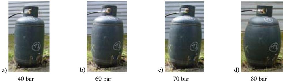
Figura 7 - Deformazione del bidone a crescere della pressione.
