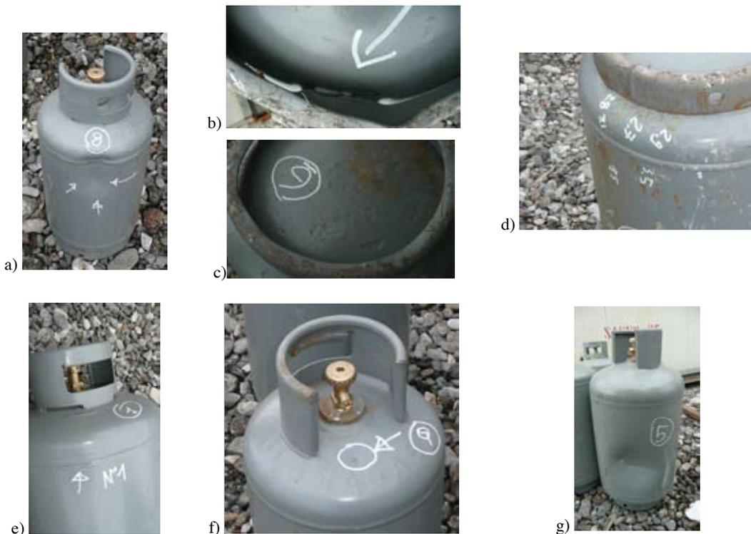
Figura 4 - Report fotografico. Tipologie di anomalie riscontrate sulle membrane
