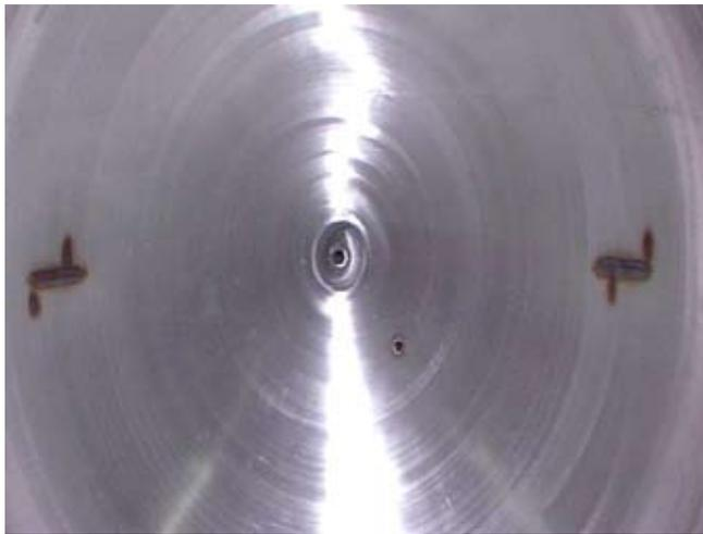
*Figura 7. Inizio di pitting sulle giunzioni saldate delle staffe interne di ancoraggio fondo*
