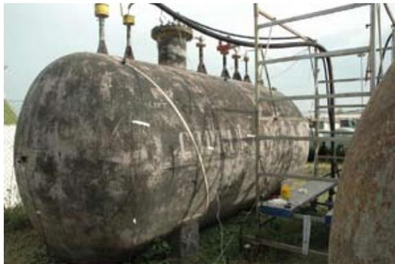
Fig. 1 - Allestimento di prova di un serbatoio da 15 m<sup>3</sup> con 2 file di 3 sensori, disposti a ore 11.05
