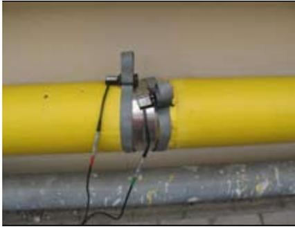
Fig. 1 - Strisce magnetostrittive e bobine applicate sulla conduttura ispezionata
