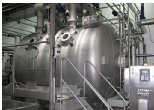
Fig. 2 - Autoclave per tinture
