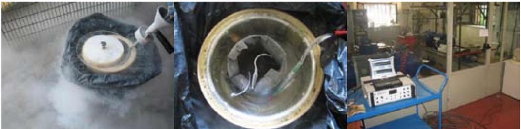
Fig. 5 - Test a  $-196\text{ }^{\circ}\text{C}$ : (a) riempimento del Dewar con azoto liquido; (b) pezzo di tubo e sensore magnetostrittivo parzialmente immerso in azoto liquido; (c) acquisizione dei dati.
