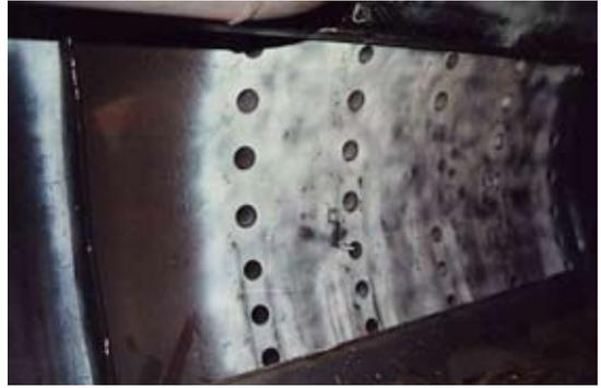
Figura 11 - Vista interna corpo cilindrico: forature ingresso miscela acqua-vapore
