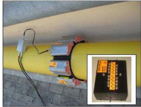
Fig. 2 - Collare magnetostrittivo e multiplexer
