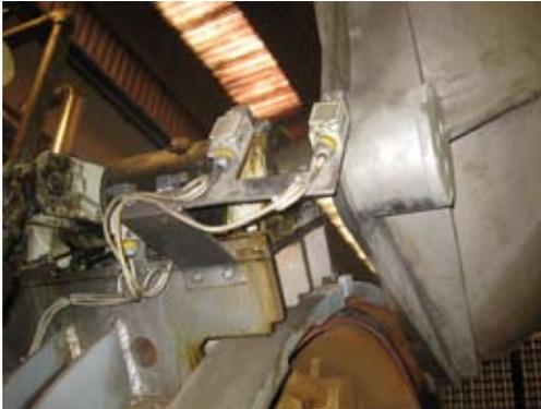
Fig. 10 - Microswitch di fine corsa
