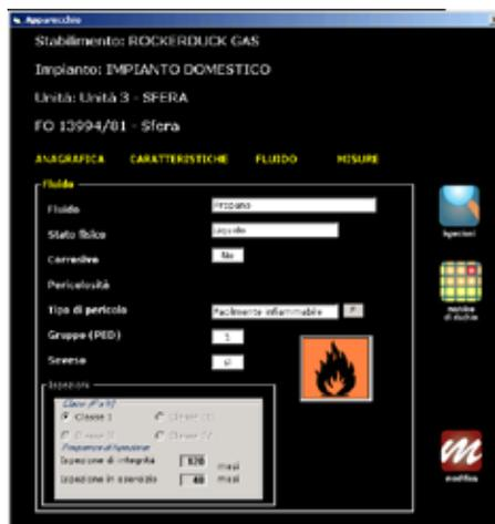
Figura 3 - Frequenze d’ispezione (Verifiche) per un’attrezzatura in pressione, come calcolate da “myInspection”.
