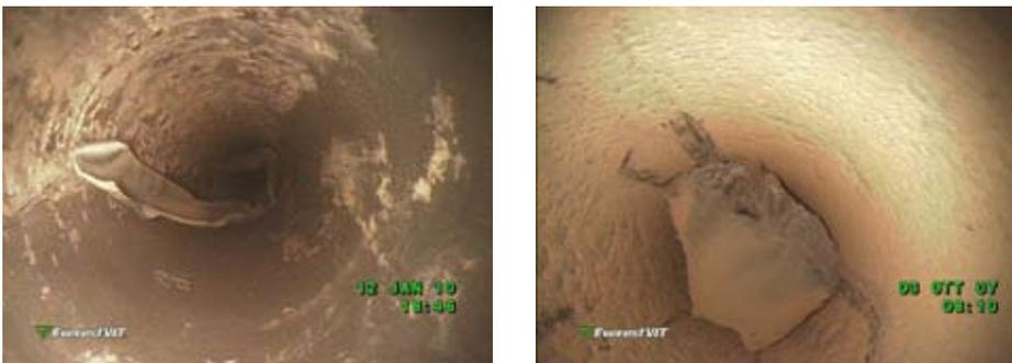
Fig. 11 - Esempio di tubi tappati e non ispezionabili con ET e RFT
