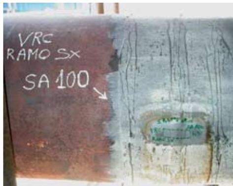
Figura 2 - Replica metallografica
