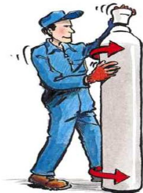
Per il posizionamento finale di una bombola, (all'interno dei cestelli o dei gas cabinet) controllarne l'equilibrio, tenendo una mano sul cappello e la bombola vicino al corpo, facendola rotolare con l'altra mano agendo sul fusto.
