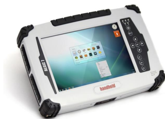
Figura 2.7 – (Immagine di sinistra) Computer da campo o tablet di tipo rugged Algiz 10X (Handheld). (Immagine di destra) Installazione dello stesso su cavalletto fotografico amagnetico assieme al telemetro laser Trupulse 360B (in foto: Ing. Matteo Facchini, ETH (Zurich), durante i rilievi idromorfologici sul Fiume Albula, Svizzera).
