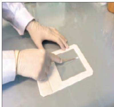
Figura 5 - Campionamento con metodica del tampone
