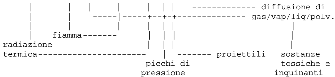
FIGURA 2 - Sviluppo dei fenomeni incendio, esplosione e rilascio di sostanze tossiche inquinanti.
