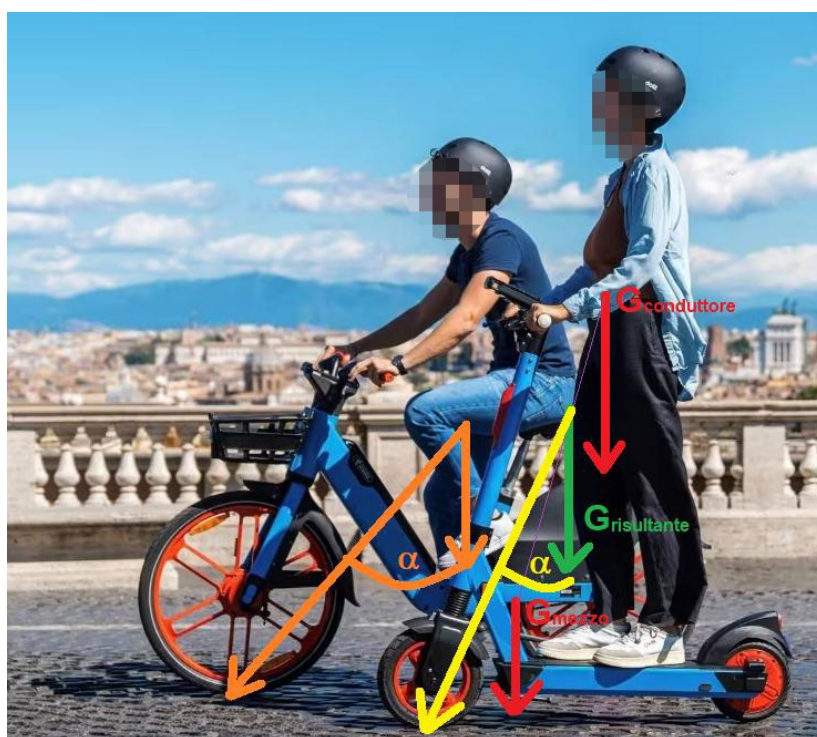
Confronto tra l'inclinazione dei vettori forza durante la massima frenata possibile, quando una forza pari a 2/3 del peso del conduttore deve essere applicata dalle braccia al manubrio
