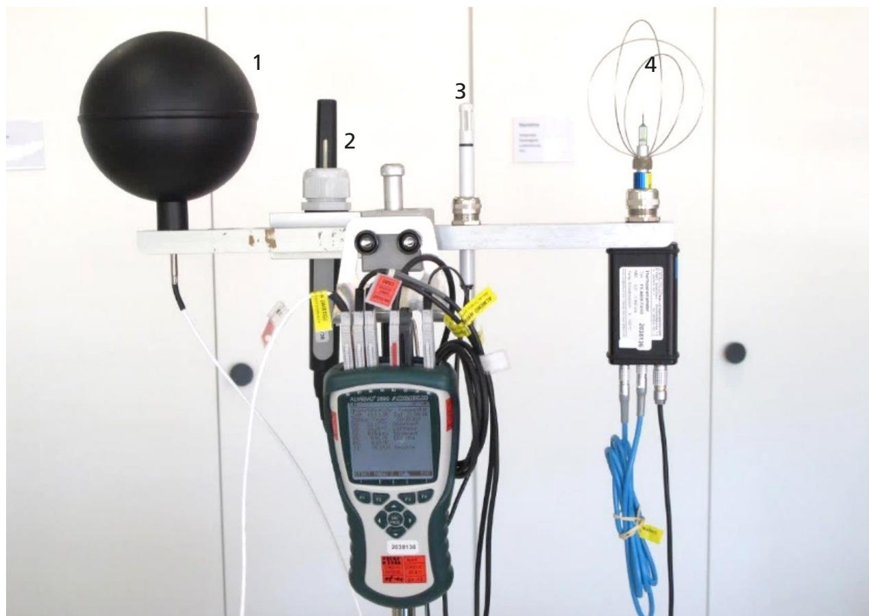
**Figura 316-12:** Unità di misura per la misurazione del clima dei locali; sensori di misurazione da sinistra a destra: termometro a bulbo (palla nera) (1), sensore per CO<sub>2</sub> (2), sensori per umidità relativa, temperatura dell'aria e pressione atmosferica (3), sensore per velocità dell'aria (4).
