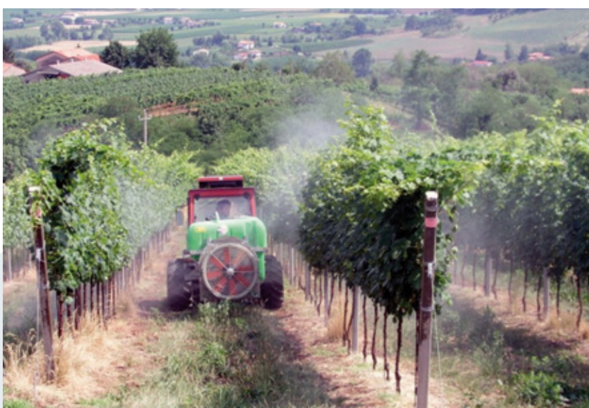
Polverizzazione troppo fine delle gocce che provoca effetto deriva
