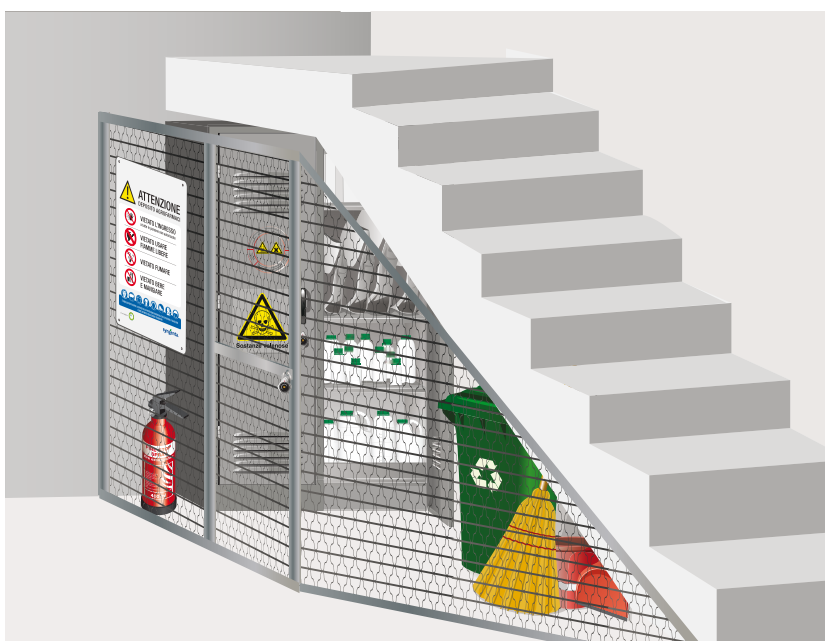
Area specifica all'interno di un magazzino adibita allo stoccaggio dei prodotti fitosanitari
