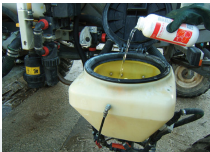
Riempimento dell'irroratrice mediante premiscelatore
