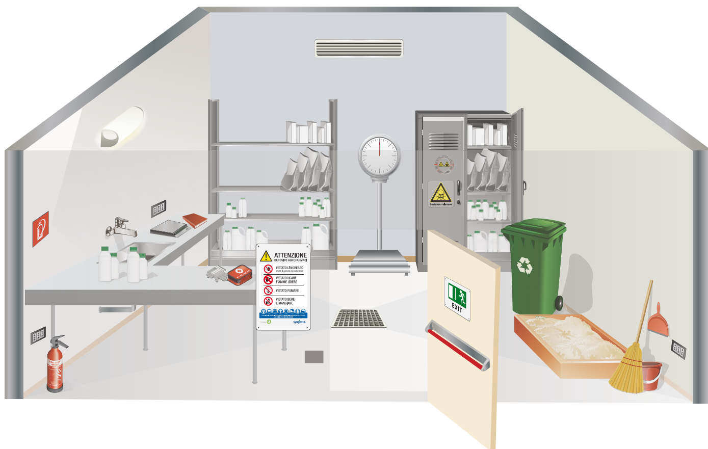
Locale specifico per lo stoccaggio dei prodotti fitosanitari
