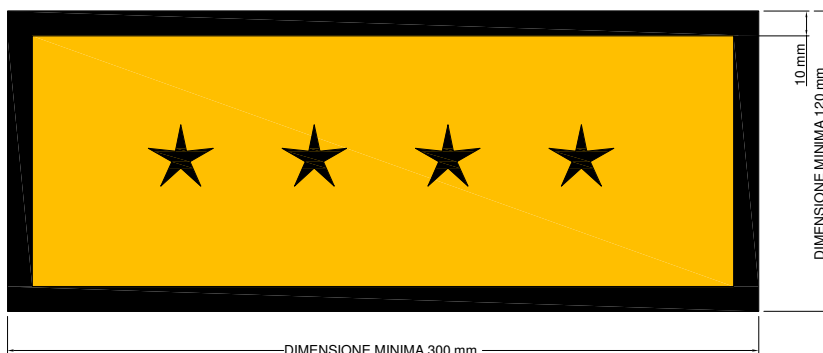
Figura 7: Placca per mostrare separatamente il numero ONU. Il colore dello sfondo della placca deve essere arancione e il bordo e il numero ONU devono essere neri. Il simbolo “****” indica lo spazio nel quale deve essere riportato l’appropriato numero ONU per il materiale radioattivo, come specificato nella Tabella 1.
