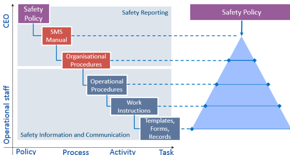
Figura 1: Tipica struttura della documentazione del SGS (Fonte: Guida ERA - Requisiti del sistema di gestione della sicurezza per la certificazione della sicurezza o l'autorizzazione di sicurezza V 1.3 del 26/04/2021)
