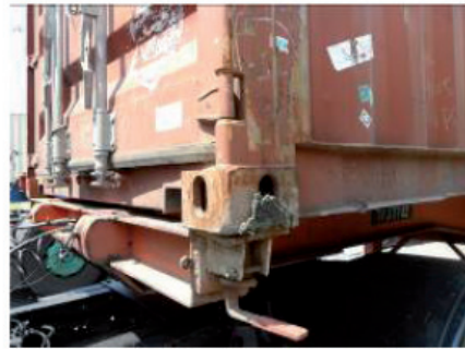
Abbildung 6.2: Schmutz in einem Eckbeschlag
