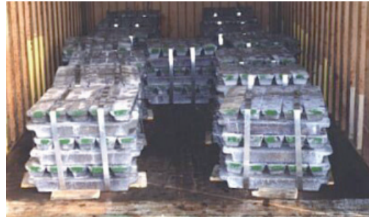
Abbildung 7.19: Mit Stahlbändern zusammengefasste Metallbarren (nicht abgeschlossene Sicherung)
