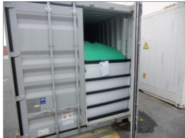
Abbildung 7.51: Container mit flexiblem Tankbehälter
