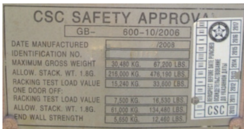
Abbildung 4.2: CSC-Sicherheits-Zulassungsschild mit dem nächsten Überprüfungsdatum
