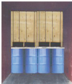
Abbildung 7.27: Gemischte Stauung, trockene über nassen Gütern
