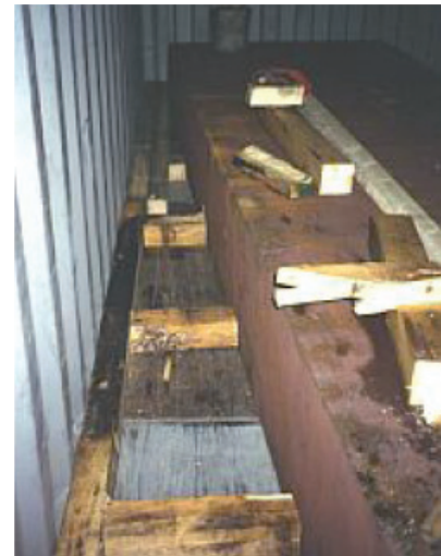
Abbildung 7.45: Querverblocken einer Bramme
