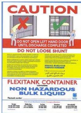
Abbildung 5.17: Kennzeichnung von flexiblen Tankbehältern
