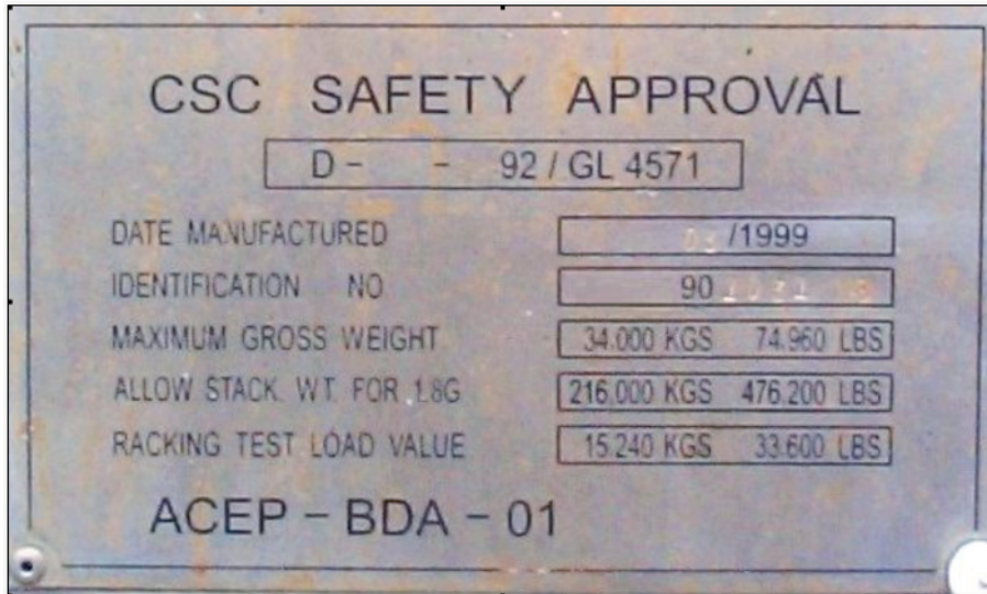
Abbildung 4.3: CSC-Sicherheits-Zulassungsschild mit ACEP-Kennzeichen
