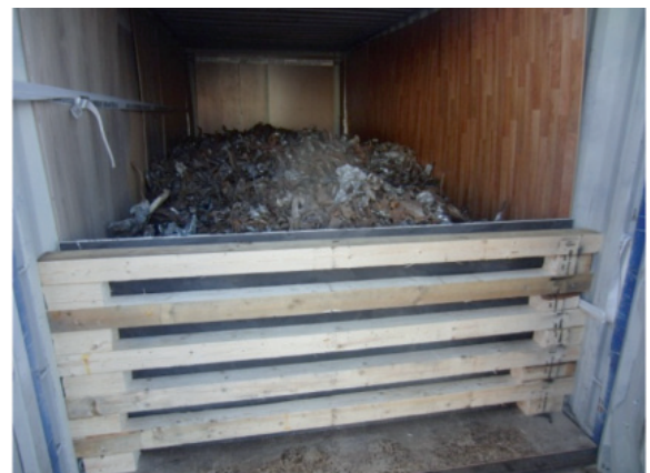
Abbildung 7.55: CTU mit Wandverkleidungen und Türbarriere, die mit Schrott beladen ist
