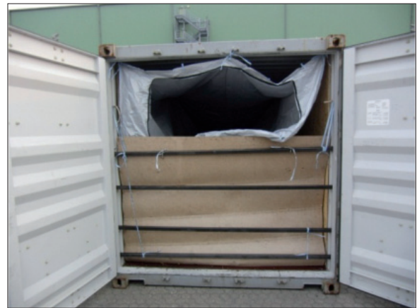
Abbildung 7.54: CTU mit Innenbeutel zur Aufnahme einer empfindlichen Schüttladung
