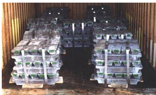
图 7.19 用钢条一体化的金属锭（尚未完成系固）
