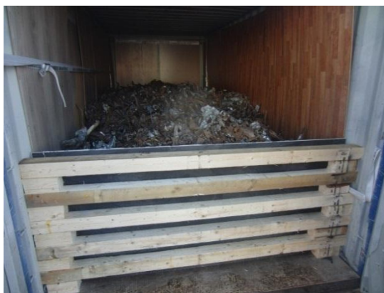
图 7.55 具备墙壁衬里和门栏的装载了废料的货运单元
