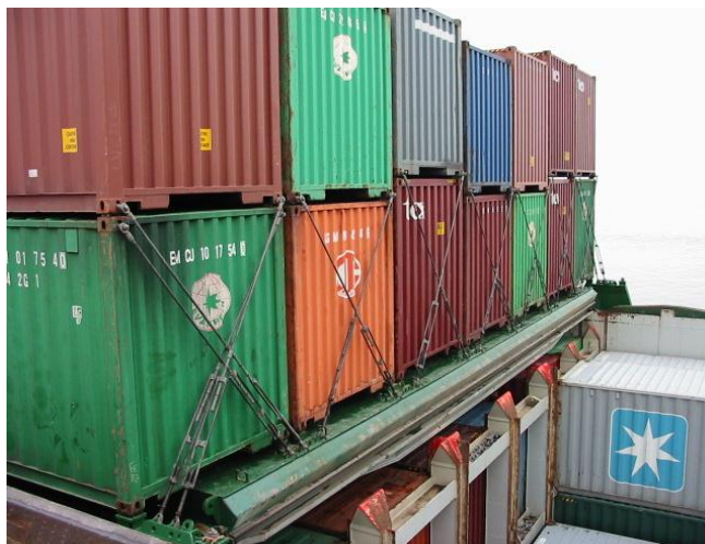
图 2.2 集装箱船上的蜂巢导轨和绑扎杆
