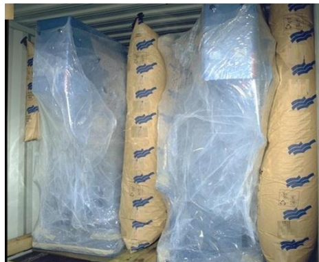
图 7.10 用衬垫袋阻塞的异形包装件
