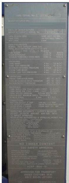
图 4.11 典型槽罐数据牌
