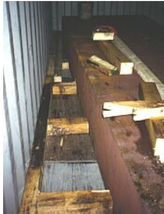
الشكل 45.7 - تثبيت مستعرض لألواح الفولاذ الصلب
