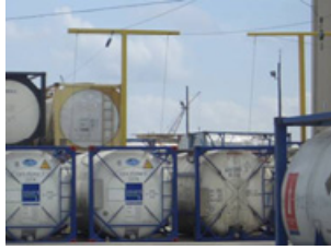
الشكل 12.8 - دعائم فولاذية مانعة للسقوط
