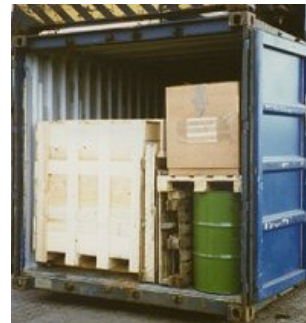
الشكل 28.7 - تستيف مختلط ، مع استخدام ألواح تحميل
