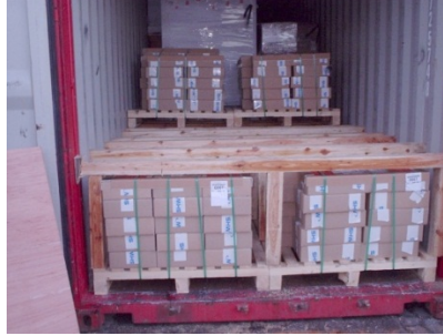
الشكل 2.7 - أرضية مؤقتة من الخشب
