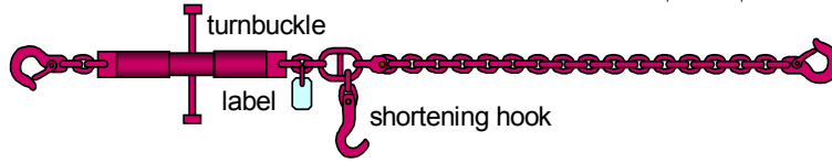
الشكل 18.7 - سلسلة تحزيم مقياسية مجهزة بخطاف تقصير
