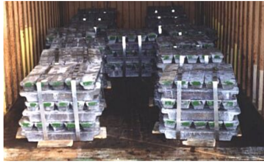
الشكل 19.7 - تجميع سبائك معدنية في وحدات بواسطة أشرطة فولاذية (رصّ غير مكتمل)
