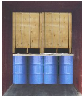
الشكل 27.7 - تستيف مختلط ، سلع جافة فوق سلع رطبة
