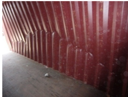
الشكل 50.7 - جدار جانبي متضرر في وحدة لنقل البضائع
