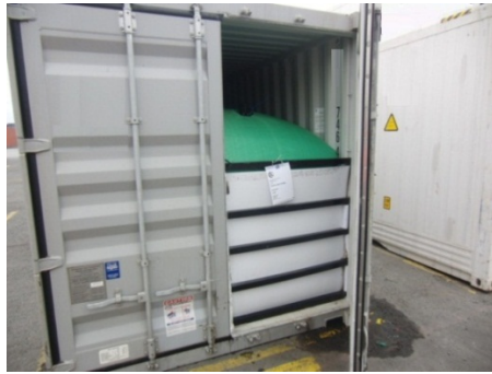
الشكل 51.7 - حاوية مجهزة بصهريج مرن
