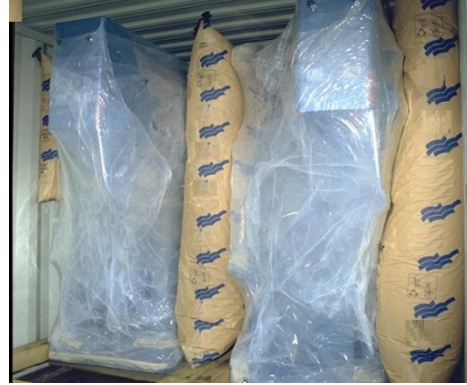
الشكل 10.7 - طرود ذات أشكال غير منتظمة جرى تثبيتها بواسطة أكياس حشوات الرغد
