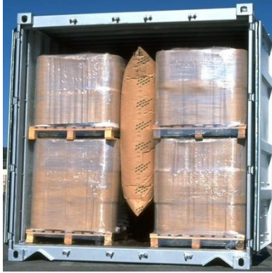
الشكل 9.7 - مساحة خاوية مملوءة بكيس حشوات الرغد في الوسط
