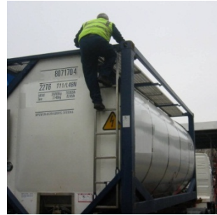
الشكل 7.8 - الانتقال من السلم إلى الممر الطولي
