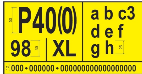
الشكل 5.4 - علامة التشغيل الصفراء للمقطورات
