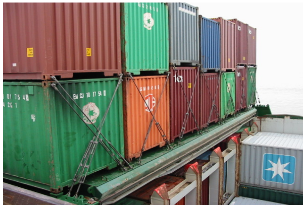
الشكل 2.2 - الخلايا الدليلية وقضبان التحزيم على متن سفينة حاويات
