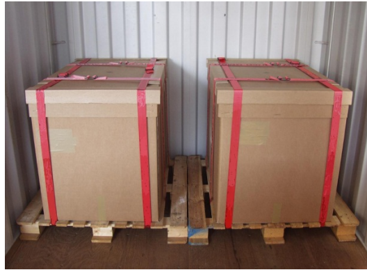
الشكل 8.7 - بضاعة مرصوفة بإحكام إلى ألواح تحميل بواسطة أربطة تحزيم مصنوعة من الألياف
