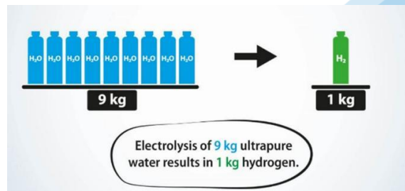
Figura 17 - Acqua (pura) necessaria al processo di elettrolisi
