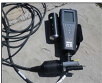
Fig 6.2 - Sonda da campo multiparametrica
