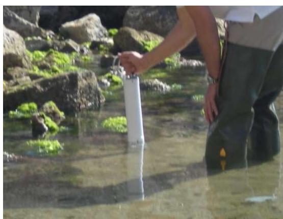
Fig 13.3 - misura dei parametri chimico-fisici con sonda multiparametrica
